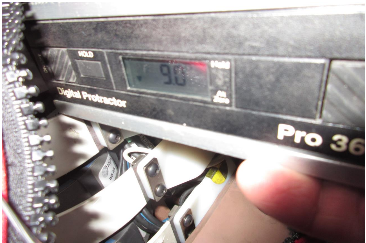
107 WorldSID-05F Thorax Rib 2 Inclinometer
