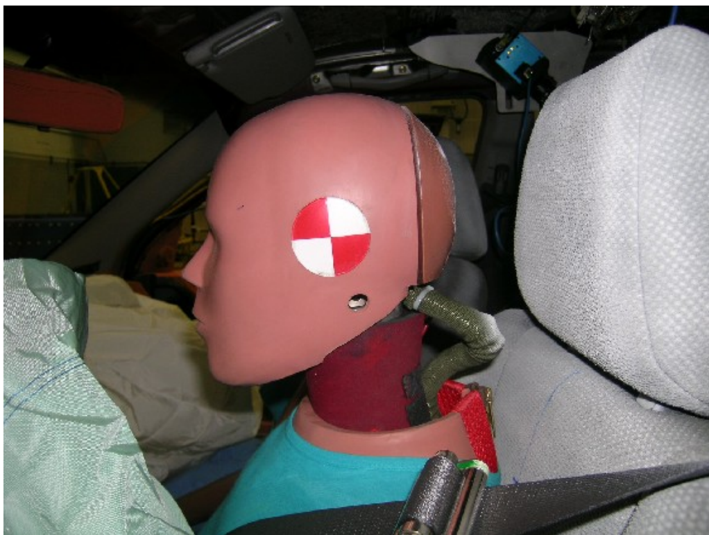
27. Point de contact de tête du conducteur, après essai. Driver's head contact point, post-test.
