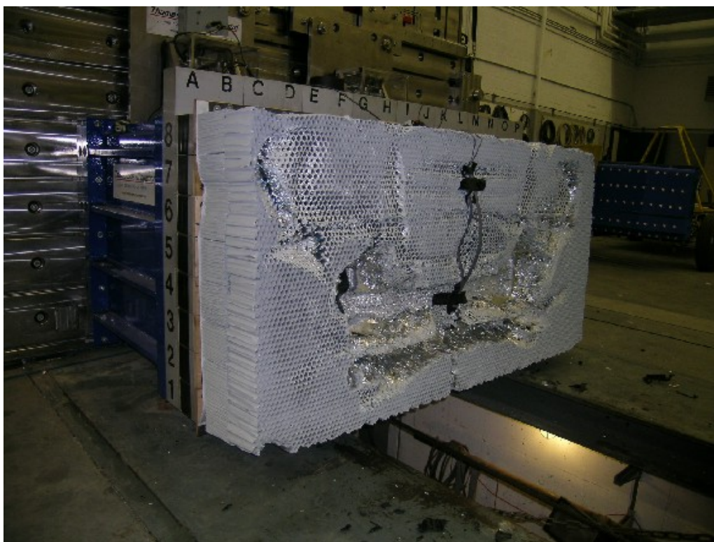
46. Vue \frac{3}{4} droit de la Face Déformable, après essai. \frac{3}{4} right view of the Deformable Face, post-test.
