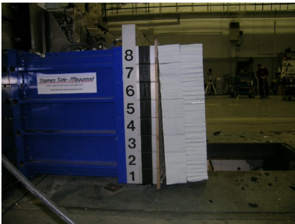
40. Vue latérale droit de la Face Déformable, après essai. Right side view of the Deformable Face, post-test.
