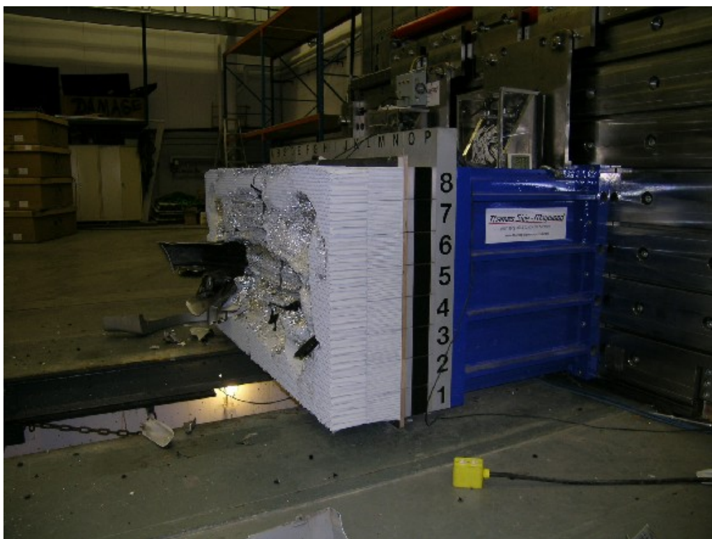
48. Vue \frac{3}{4} gauche de la Face Déformable, après essai. \frac{3}{4} left view of the Deformable Face, post-test.
