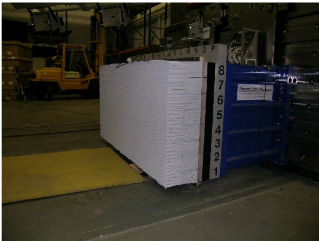
47. Vue \frac{3}{4} gauche de la Face Déformable, avant essai. \frac{3}{4} left view of the Deformable Face, pre-test.
