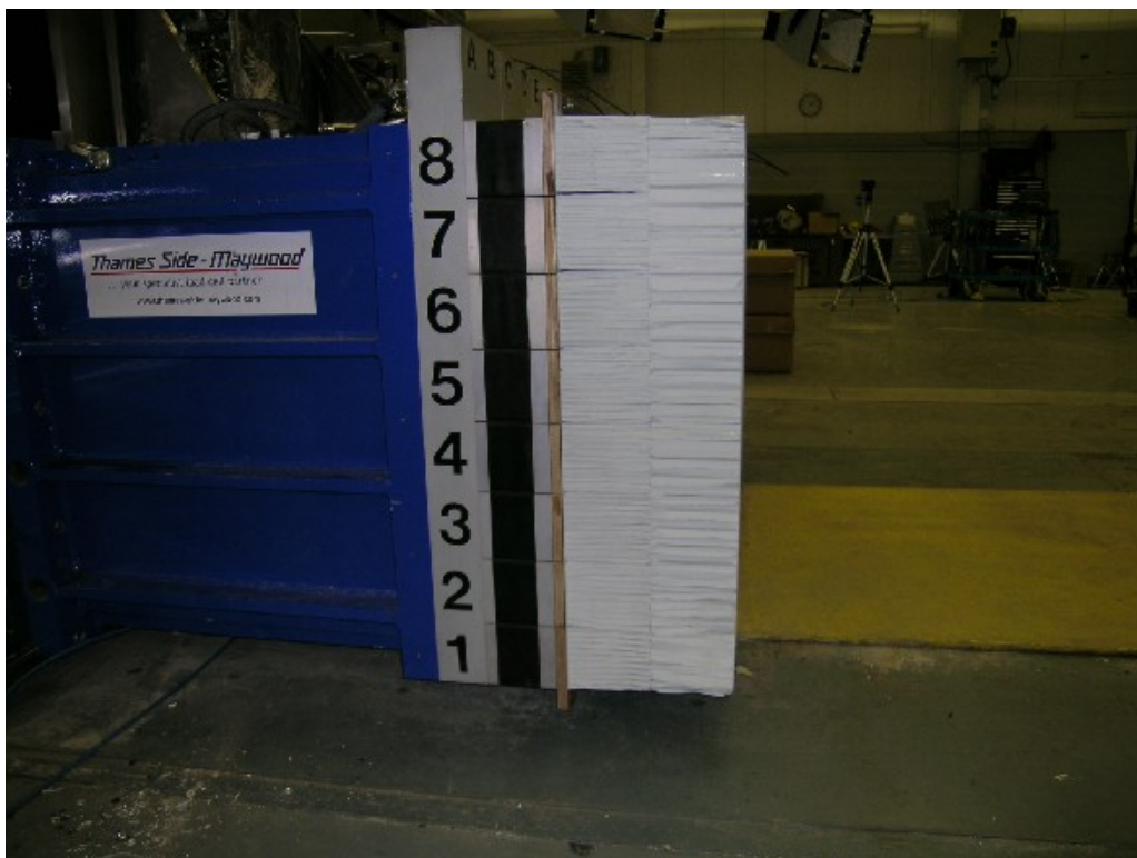
39. Vue latérale droit de la Face Déformable, avant essai. Right side view of the Deformable Face, pre-test.
