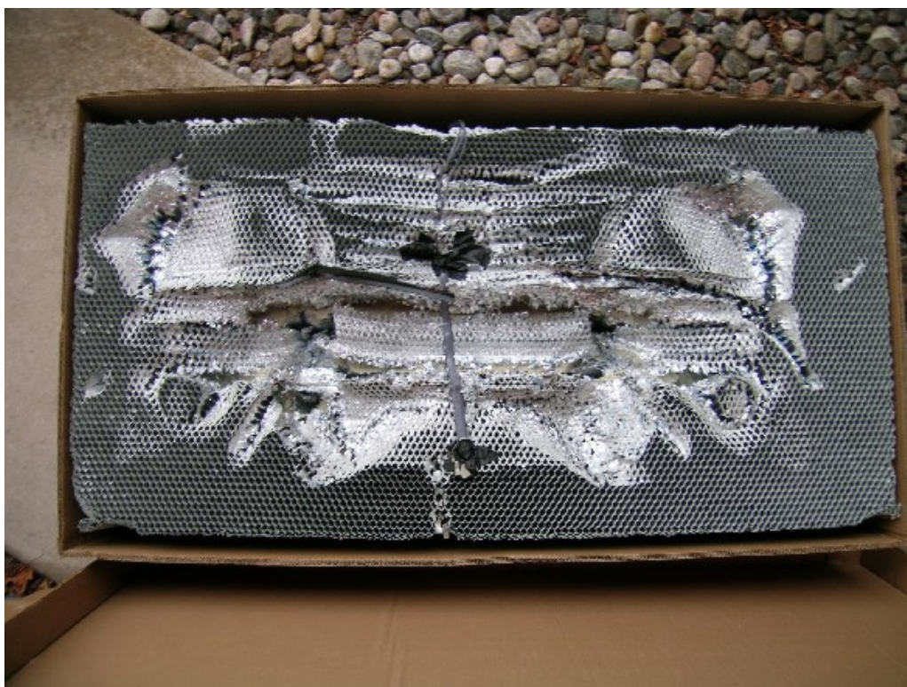
44. Vue avant de la Face Déformable, après essai. Front view of the Deformable Face, post-test.
