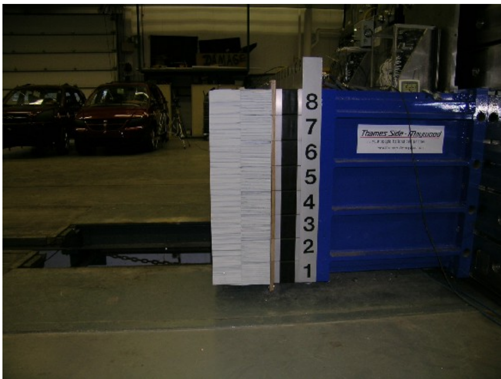
41. Vue latérale gauche de la Face Déformable, avant essai. Left side view of the Deformable Face, pre-test.
