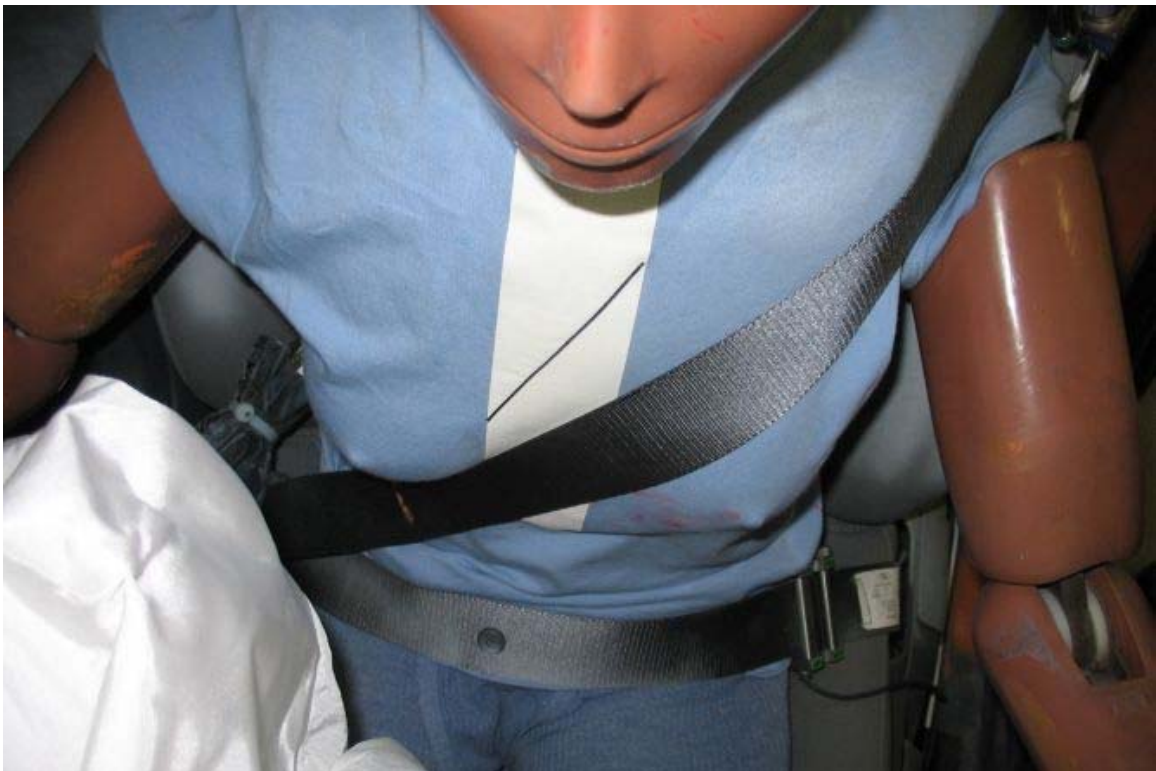
30. Contact du volant sur l'abdomen du conducteur, après essai. Steering wheel's contact point with driver's abdomen.
