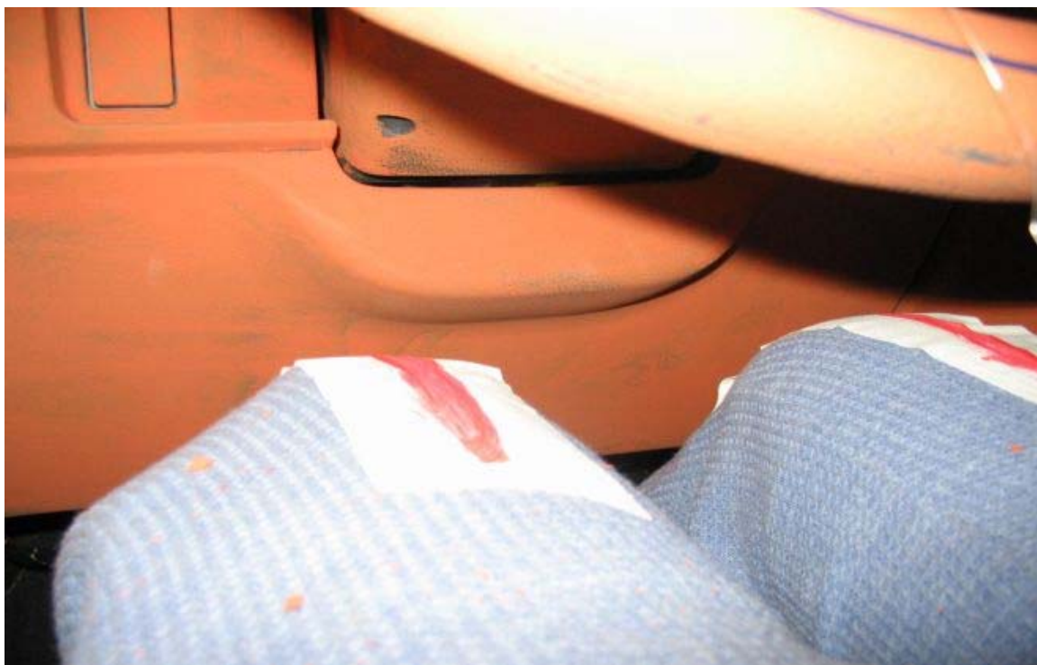
29. Point de contact des genoux du conducteur, après essai. Driver's knees contact point, post-test.
