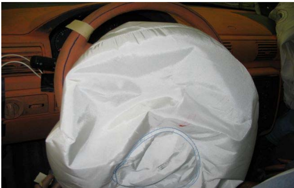
27. Point de contact de tête du conducteur, après essai. Driver's head contact point, post-test.
