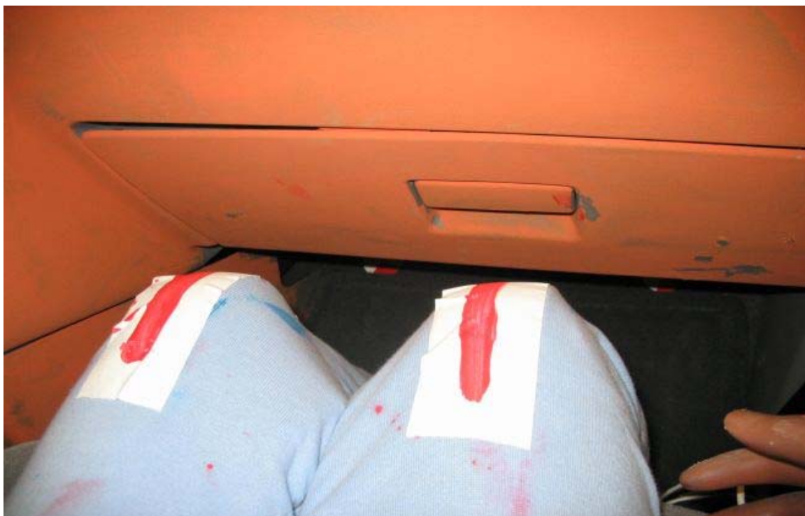
35. Point de contact des genoux du passager, après essai. Passenger's knees contact point, post-test.
