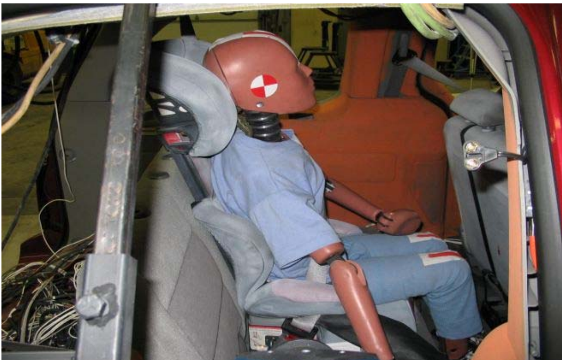
40. Position du passager arrière centre, 3 e rangée, avant essai. Rear centre passenger's position, 3 rd row, pre-test.
