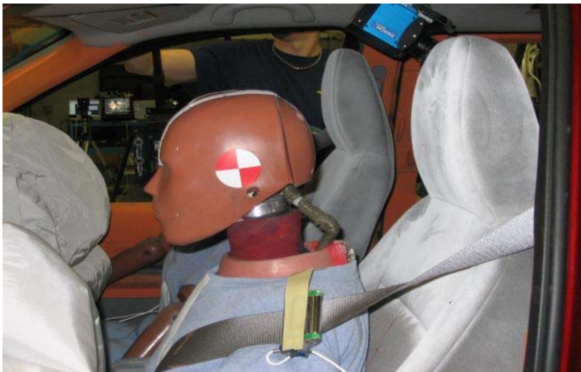
27. Point de contact de tête du conducteur, après essai. Driver's head contact point, post-test.
