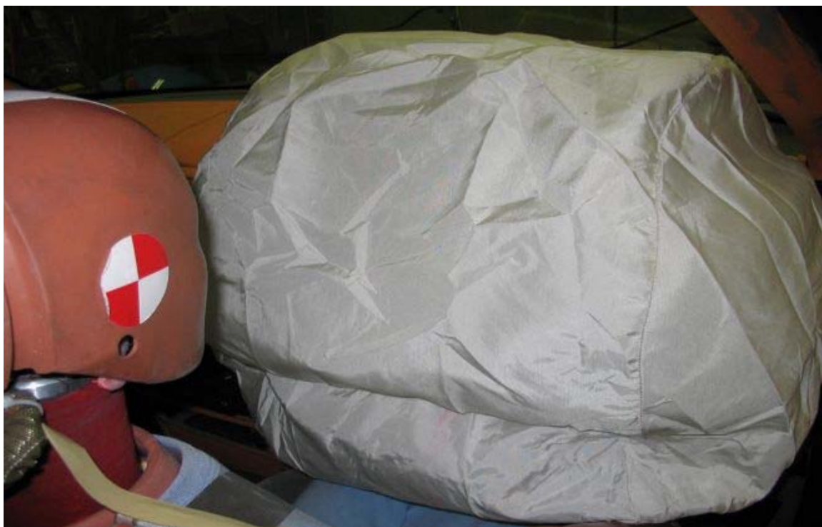
33. Point de contact de tête du passager, après essai. Passenger's head contact point, post-test.
