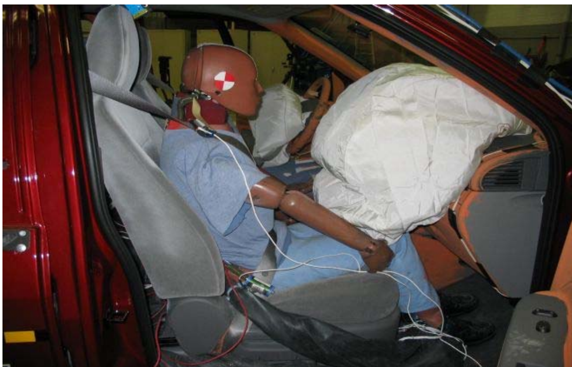
31. Position du passager, avant essai. Passenger's position, pre-test.
