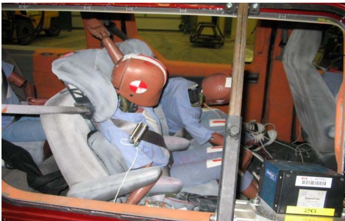
36. Position du passager arrière droit, avant essai. Rear right passenger's position, pre-test.
