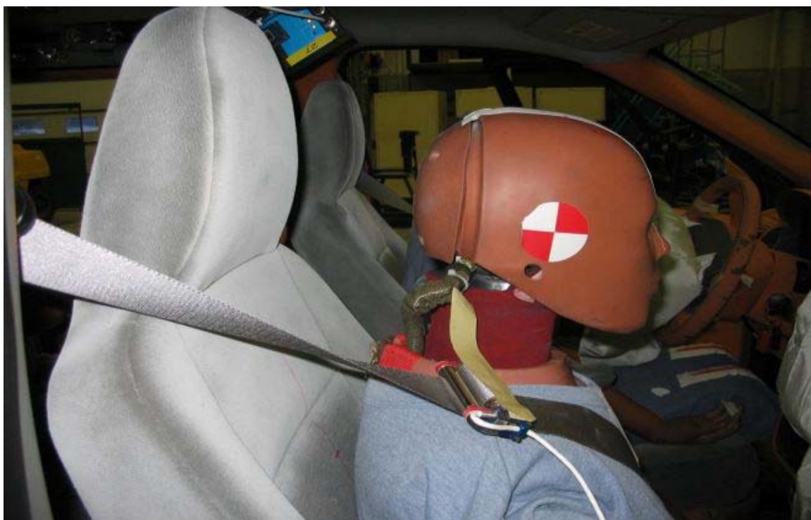
33. Point de contact de tête du passager, après essai. Passenger's head contact point, post-test.
