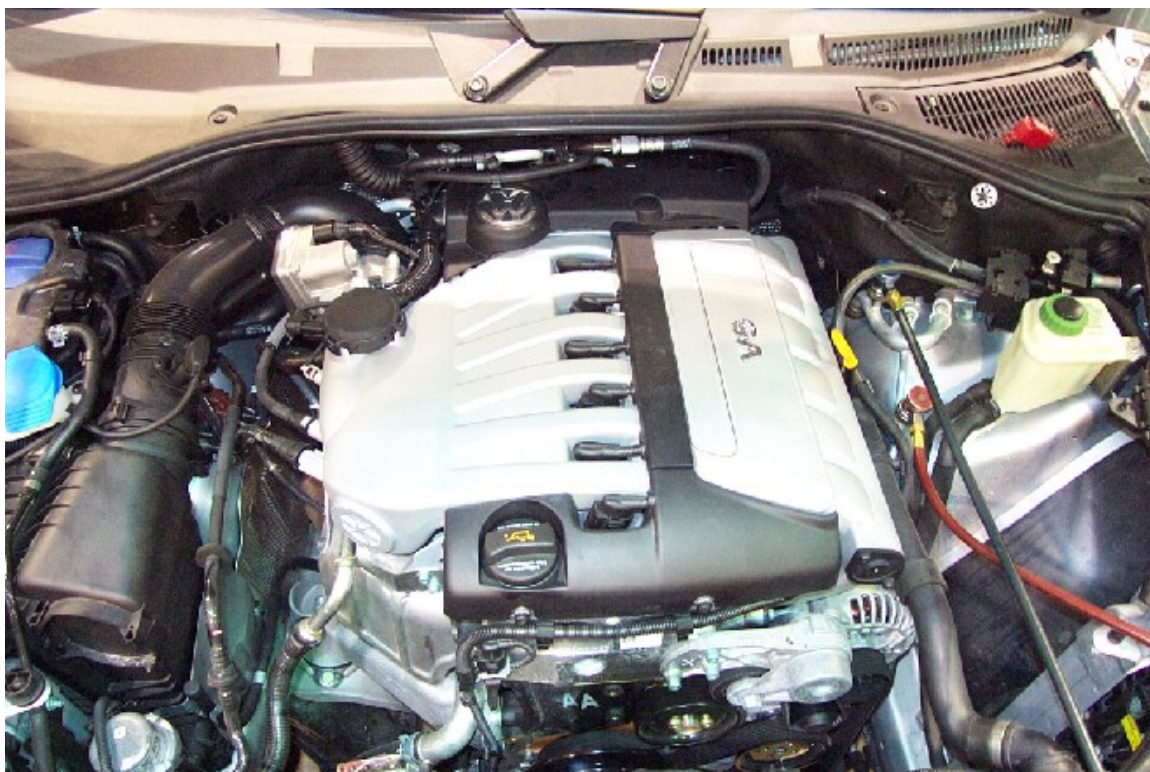
37. Lignes de carburant et vapeur dans le compartiment moteur. Filler and vapor lines in the engine compartment.
