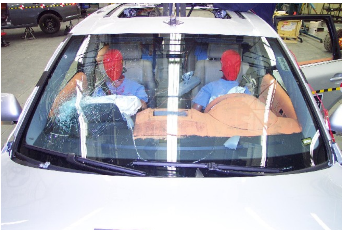
30. Pare-brise, après essai. Windshield, post-test.
