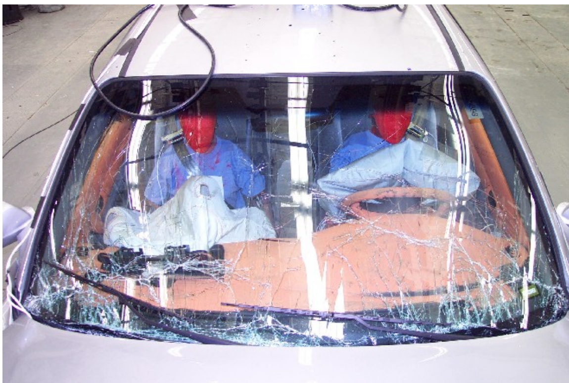
30. Pare-brise, après essai. Windshield, post-test.
