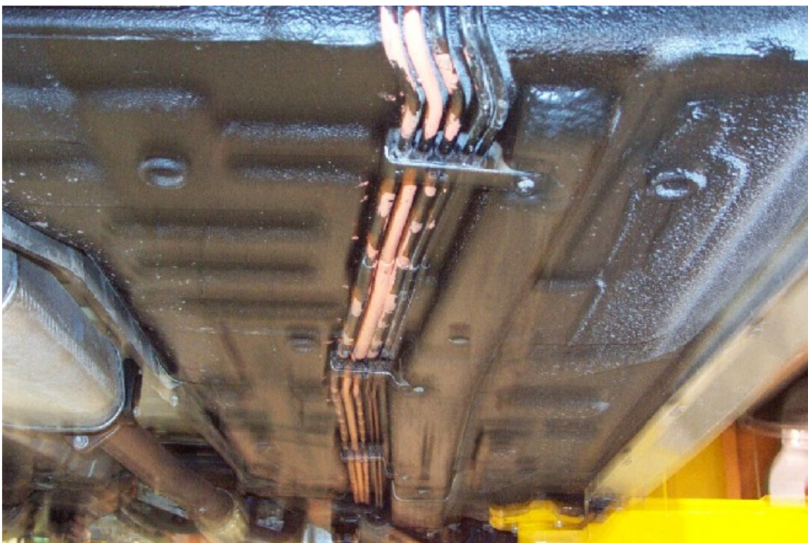
35. Ligne de carburant et vapeur. Fuel and vapor lines.
