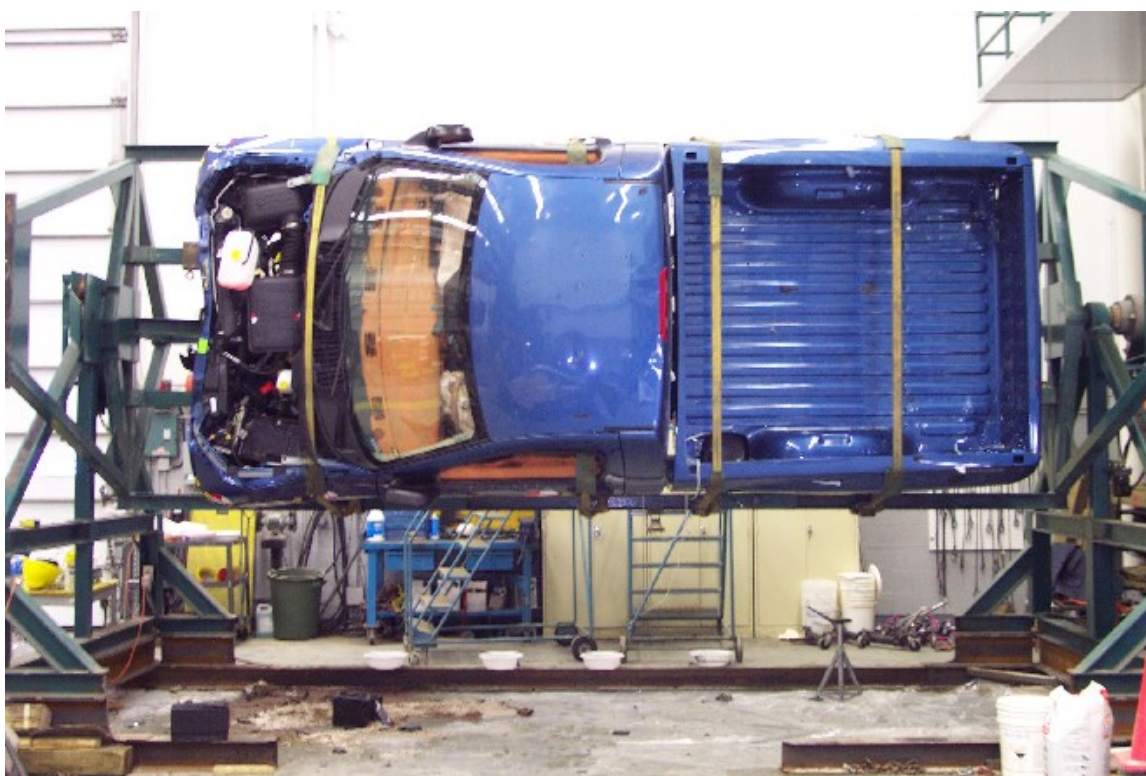
40. Vue du véhicule sur culbuteur à 90°. View of the vehicle on the roll over device at 90°.
