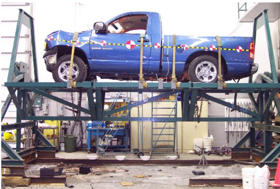
43. Vue du véhicule sur culbuteur à 360°. View of the vehicle on the roll over device at 360°.
