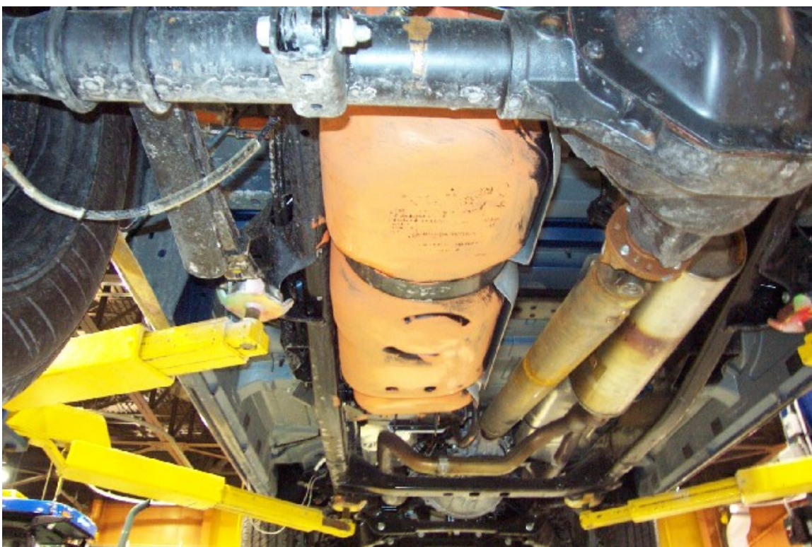
30. Réservoir de carburant. Fuel tank.
