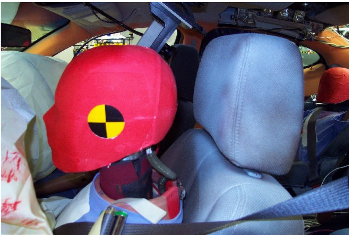
28. Point de contact de tête du conducteur, après essai. Driver's head contact point, post-test.
