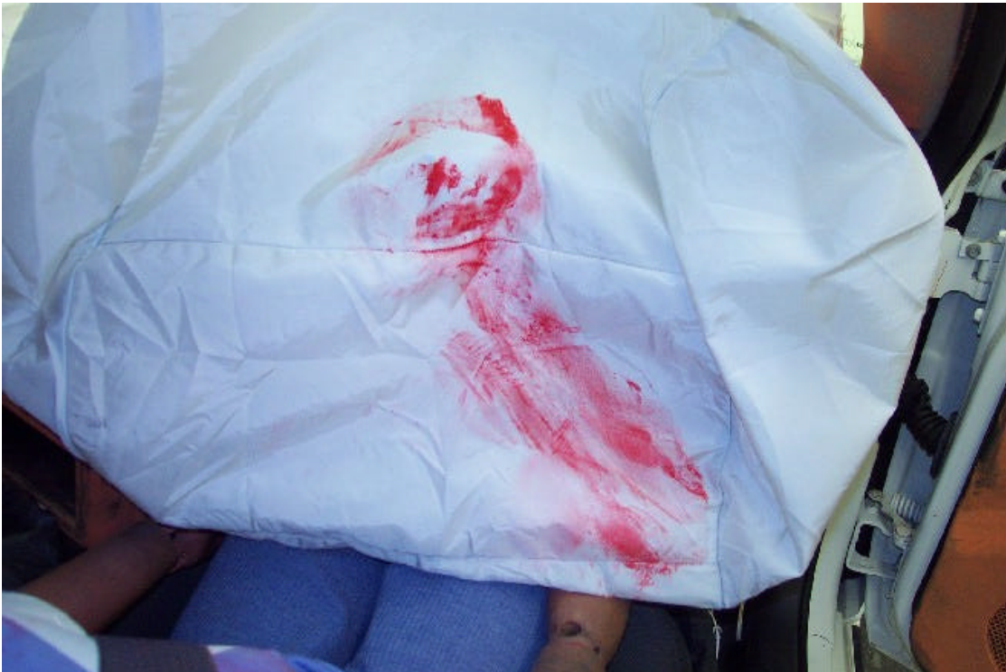
33. Point de contact de tête du passager, après essai. Passenger's head contact point, post-test.
