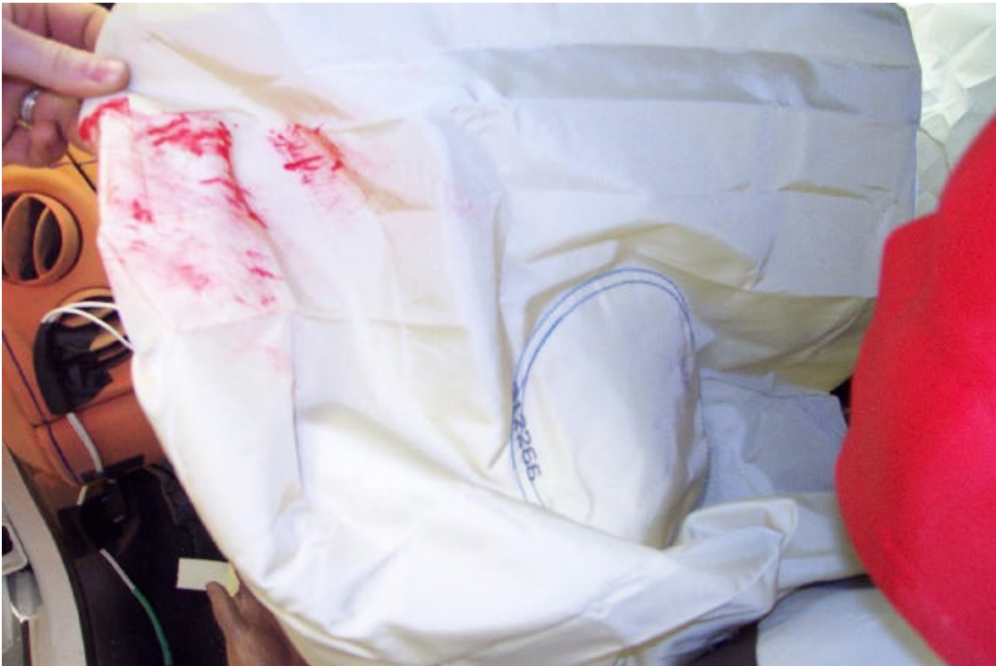
27. Point de contact de tête du conducteur, après essai. Driver's head contact point, post-test.
