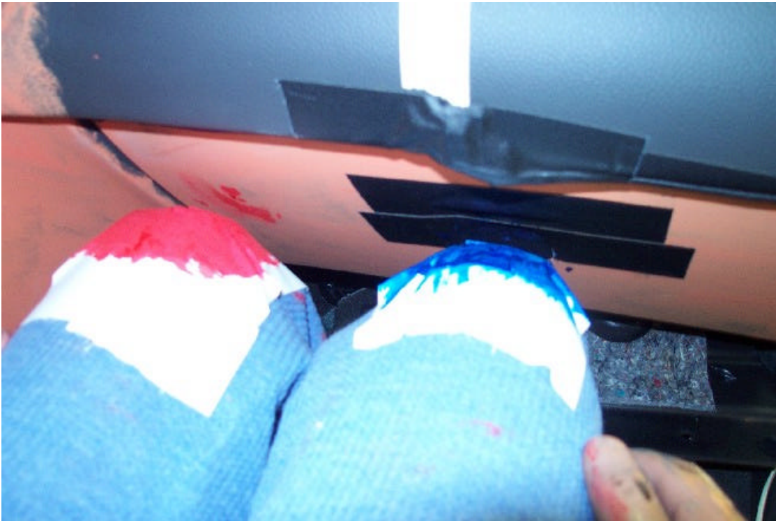
35. Point de contact des genoux du passager, après essai. Passenger's knees contact point, post-test.
