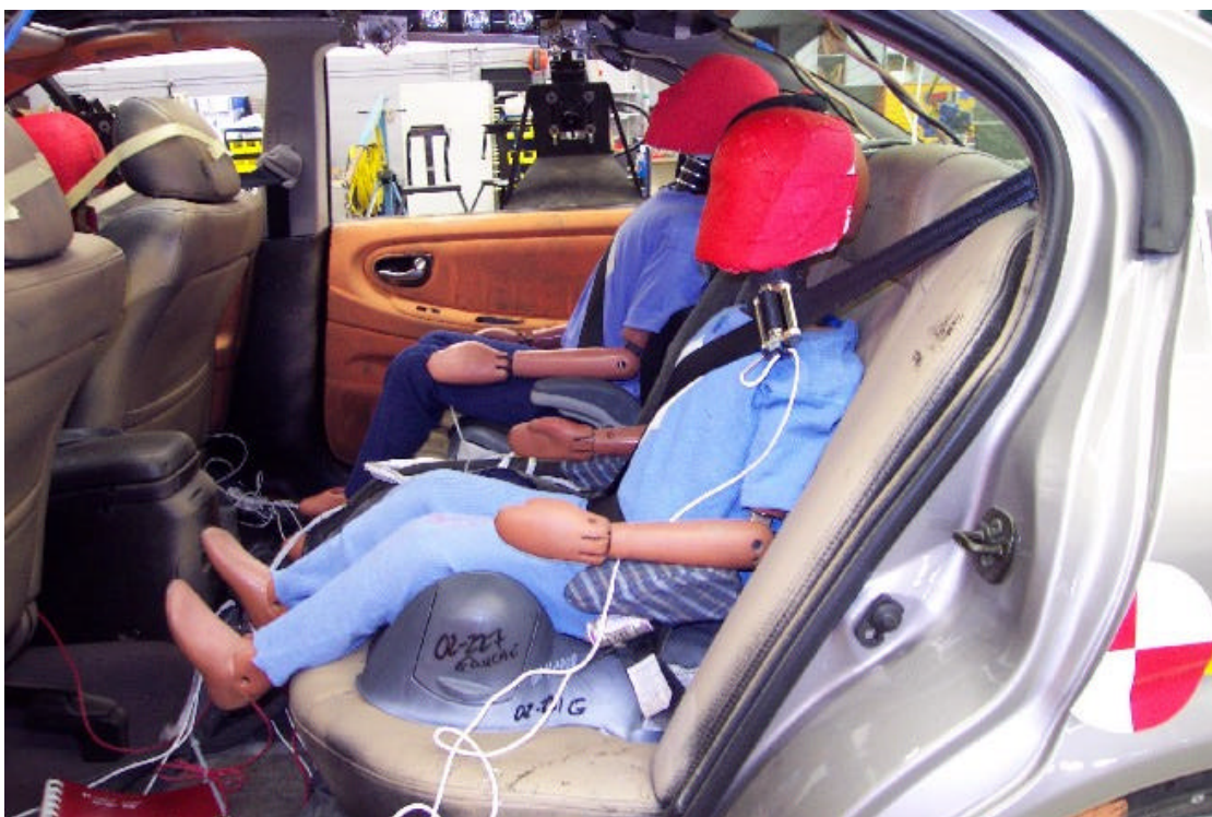
46. Position du passager arrière gauche, vue de gauche, avant essai. Rear left passenger's position, left side view, pre-test.
