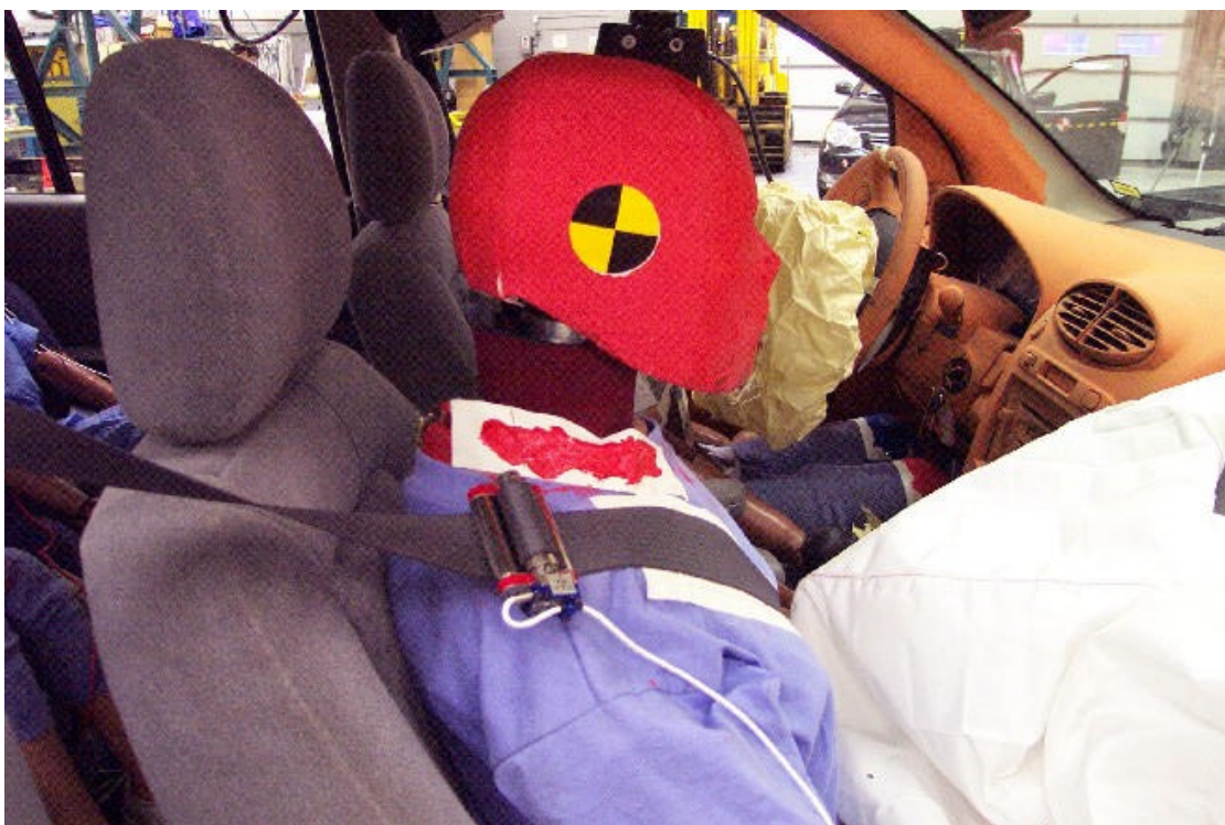
41. Point de contact de tête du passager, après essai. Passenger's head contact point, post-test.
