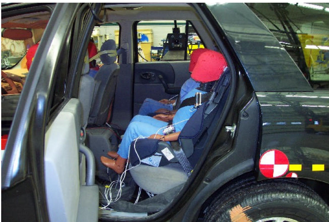
45. Position du passager arrière gauche, vue de gauche, avant essai. Rear left passenger's position, left side view, pre-test.
