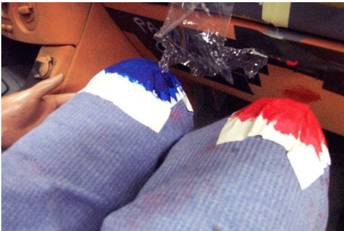
42. Point de contact des genoux du passager, après essai. Passenger's knees contact point, post-test.
