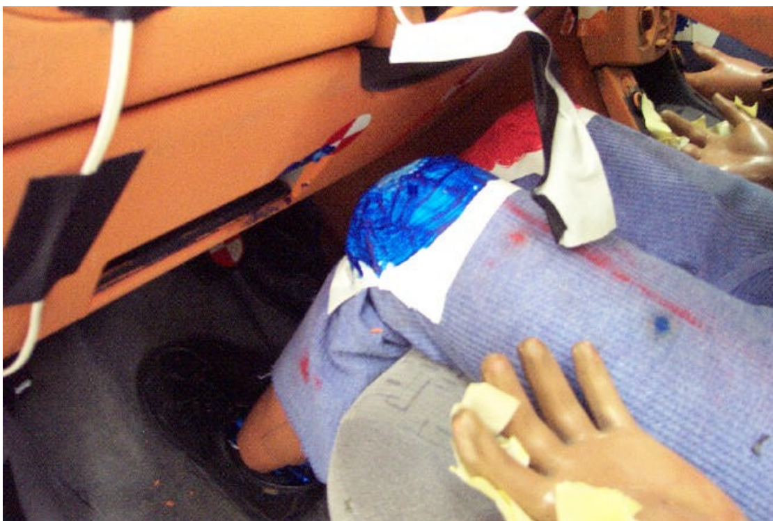
37. Point de contact des genoux du conducteur, après essai. Driver's knees contact point, post-test.
