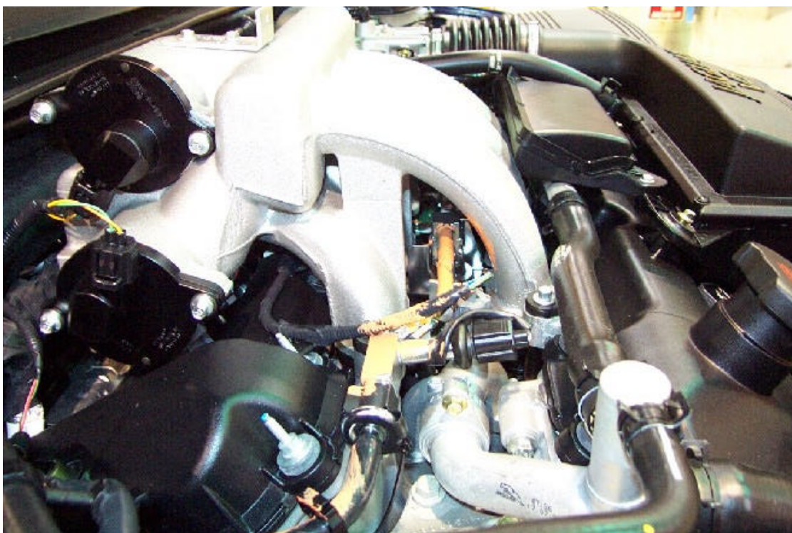
44. Lignes de carburant et vapeur dans le compartiment moteur. Filler and vapor lines in the engine compartment.
