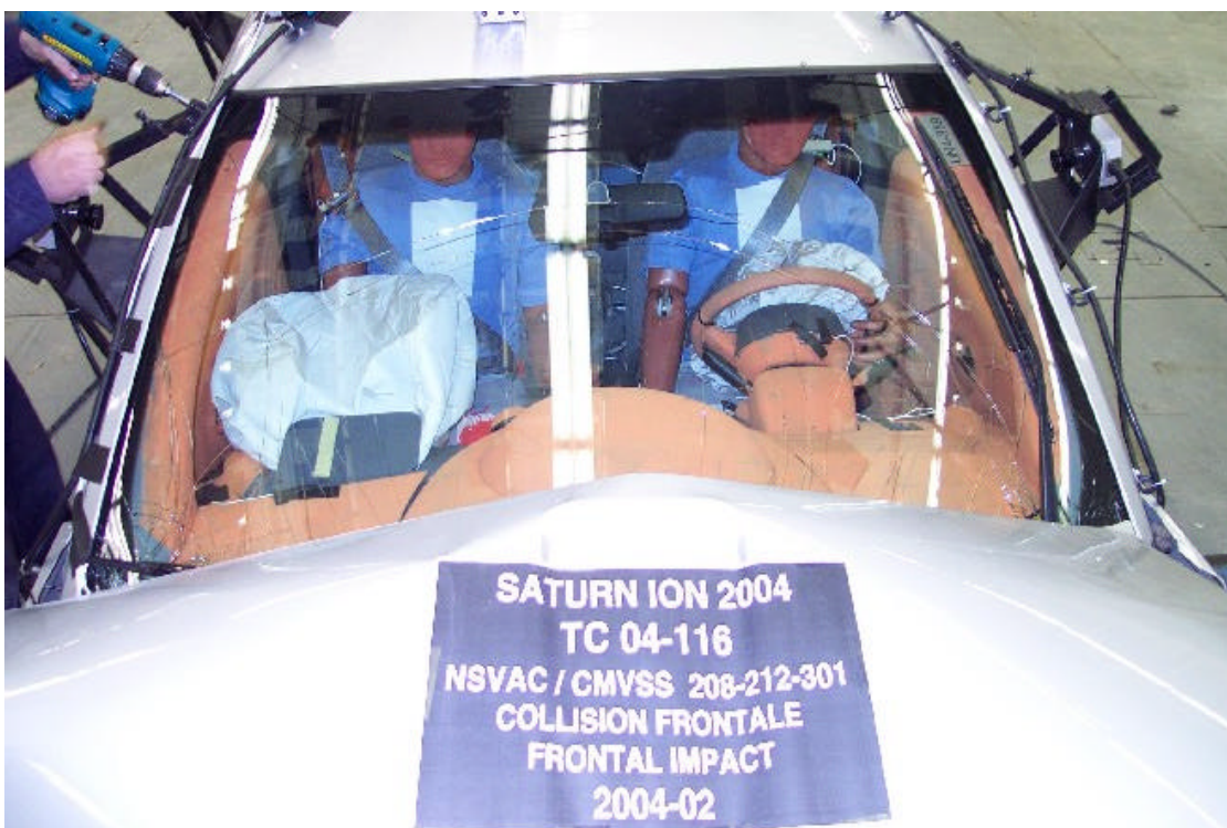
37. Pare-brise, après essai. Windshield, post-test.
