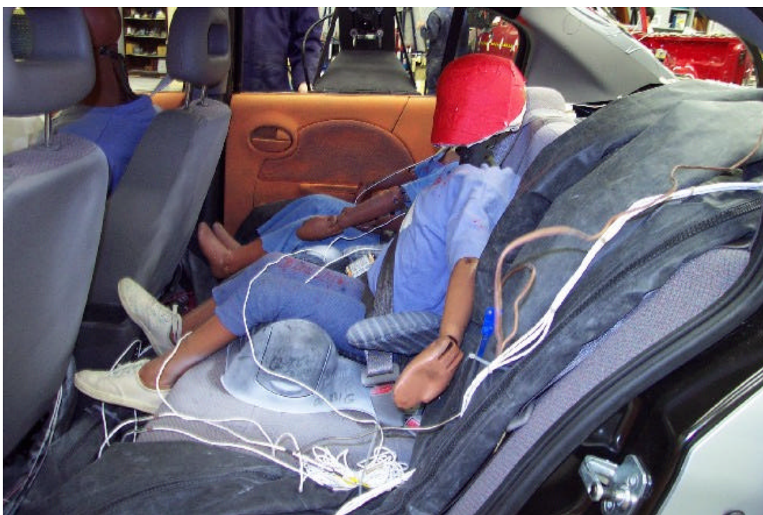
35. Position du passager arrière centre, vue de gauche, après essai. Rear center passenger's position, left side view, post-test.
