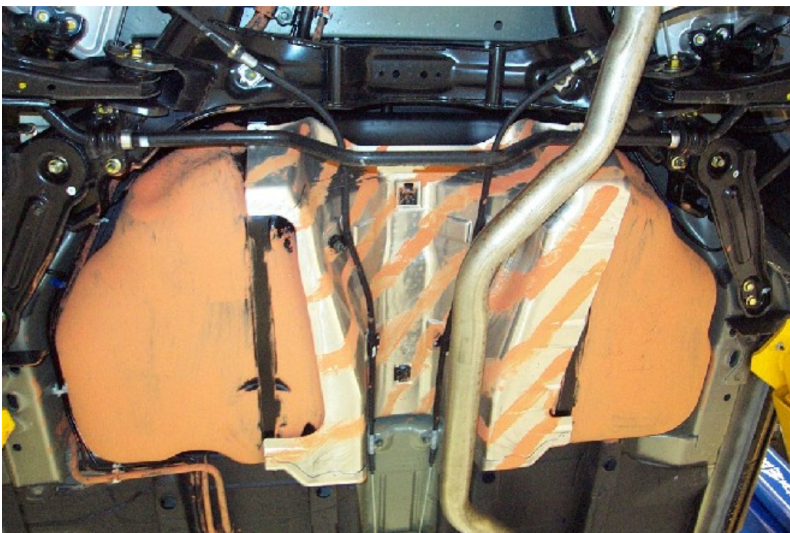
34. Réservoir de carburant. Fuel tank.
