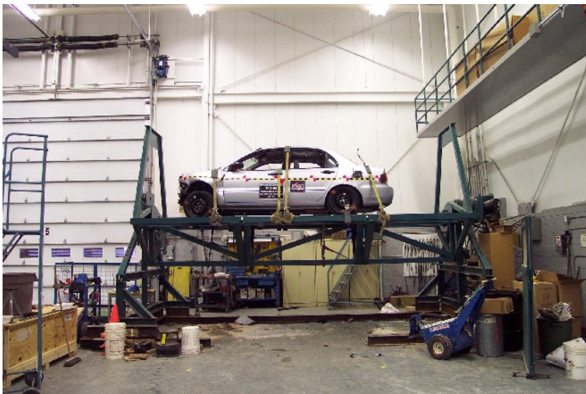
43. Vue du véhicule sur culbuteur avant l'essai de capotage statique. View of the vehicle on the roll over device before testing.
