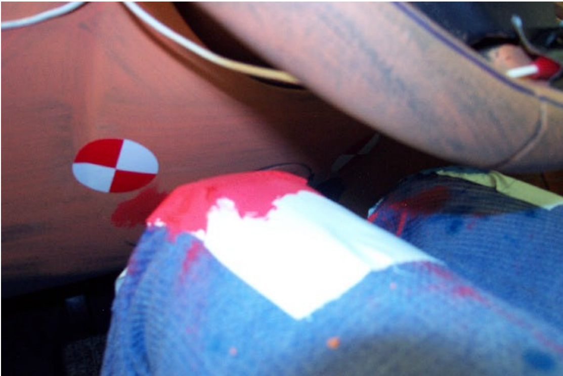
29. Point de contact des genoux du conducteur, après essai. Driver's knees contact point, post-test.
