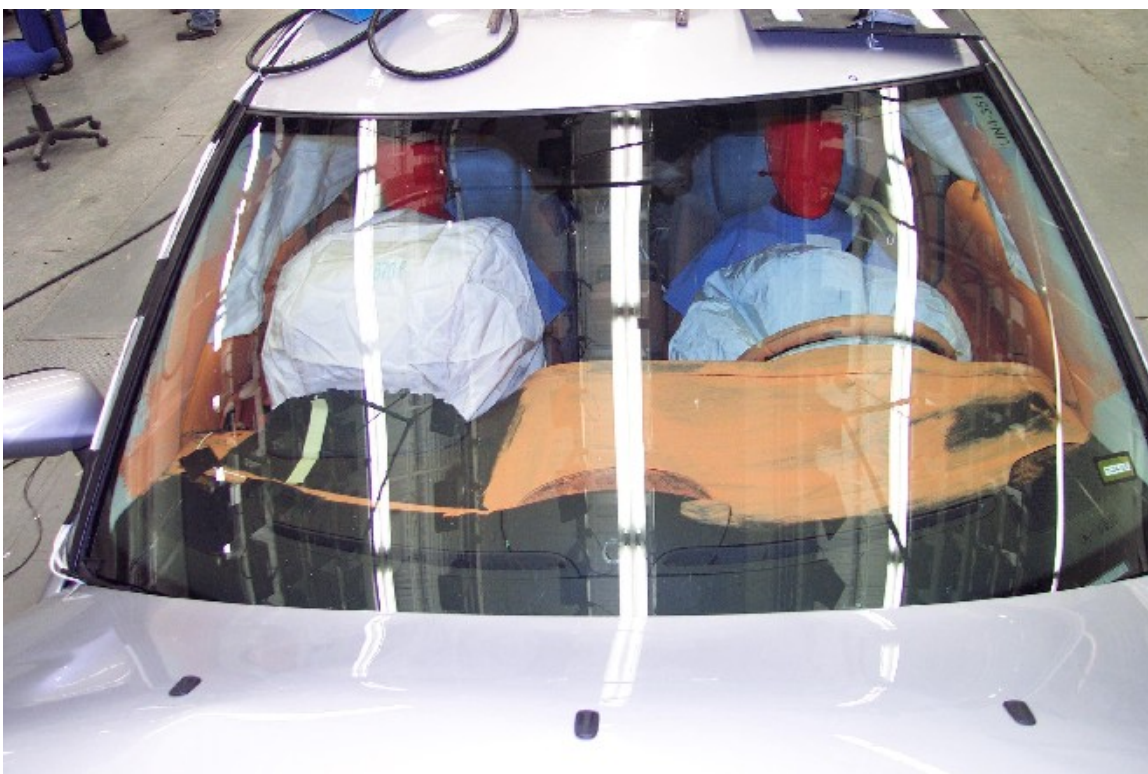
30. Pare-brise, après essai. Windshield, post-test.
