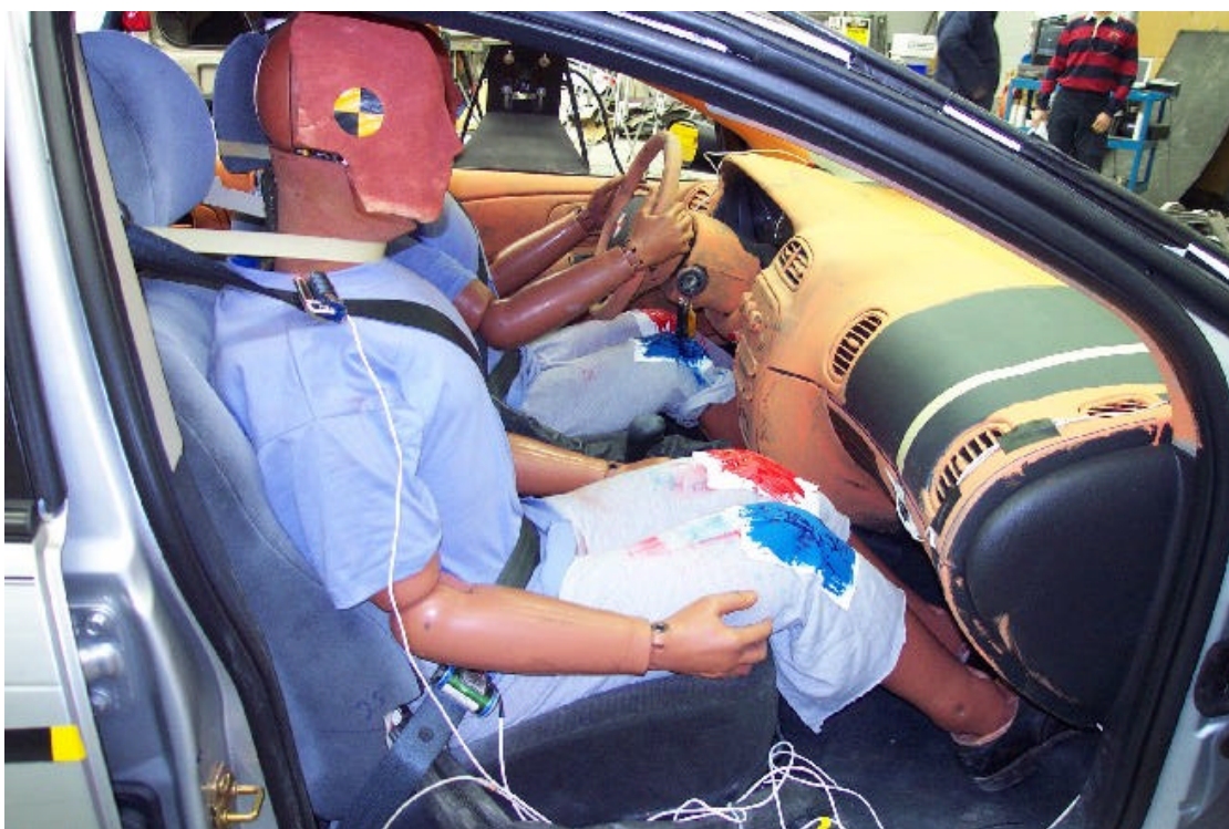
27. Position du passager, avant essai. Passenger's position, pre-test.
