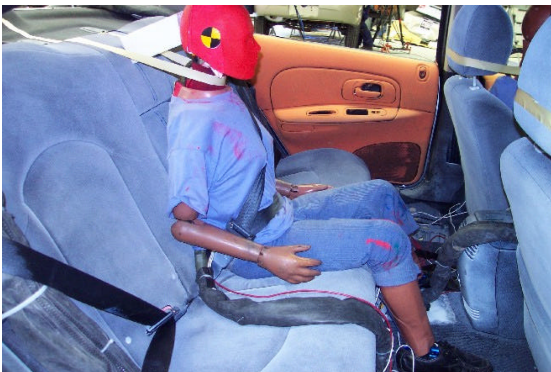
34. Position du passager arrière centre, vue de droite, avant essai. Rear centre passenger's position, right side view, pre-test.
