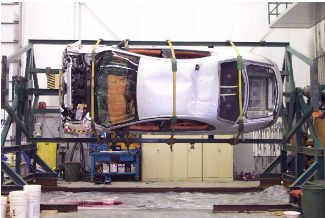
51. Vue du véhicule sur culbuteur à 90°. View of the vehicle on the roll over device at 90°.
