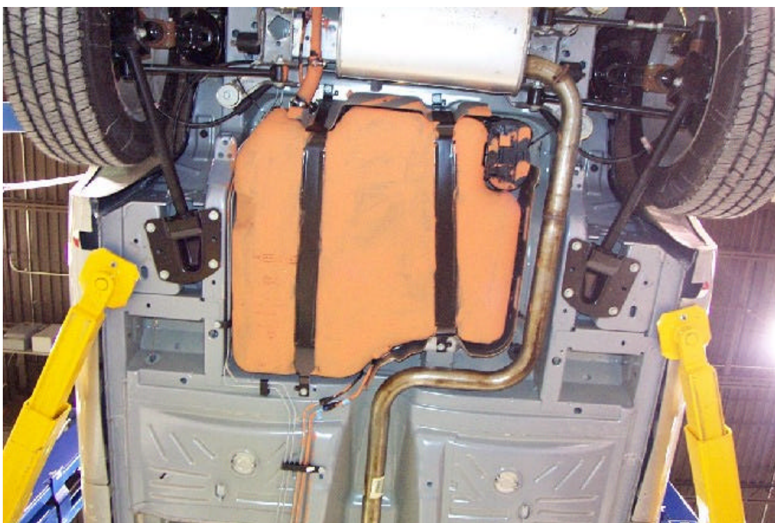
41. Réservoir de carburant. Fuel tank.
