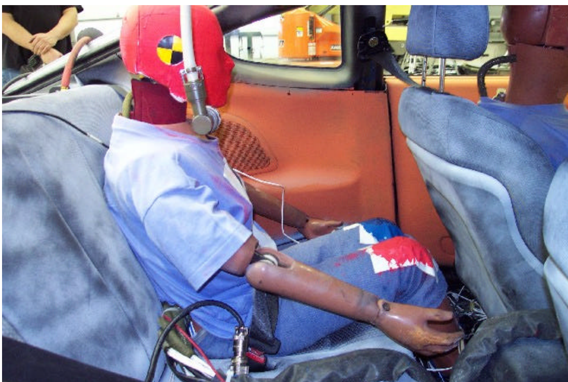
33. Position du passager arrière gauche, vue de droite, après essai. Rear left passenger's position, right side view, post-test.
