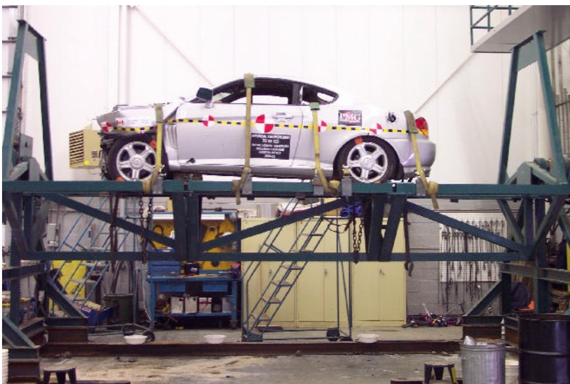
50. Vue du véhicule sur culbuteur avant l'essai de capotage statique. View of the vehicle on the roll over device before testing.
