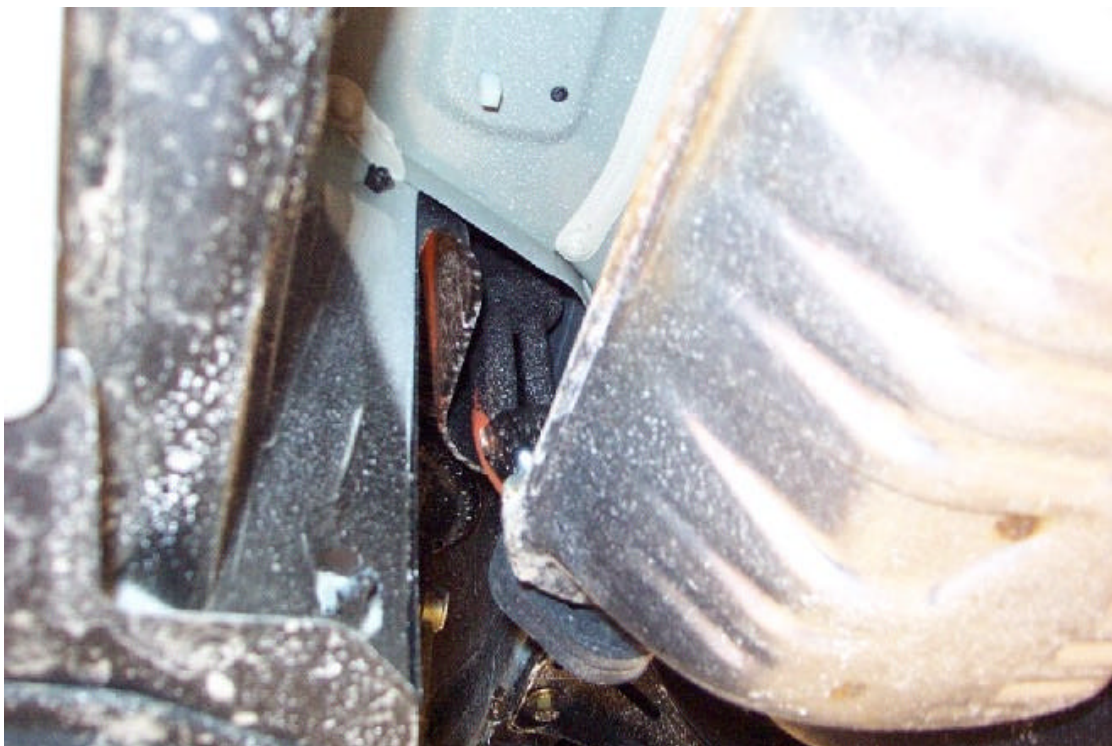
40. Tuyau de remplissage et vapeur. Filler and vapor pipe.
