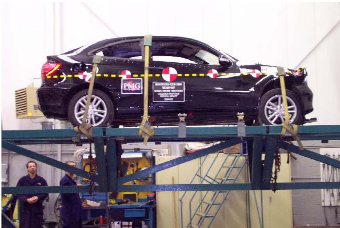
54. Vue du véhicule sur culbuteur à 360°. View of the vehicle on the roll over device at 360°.
