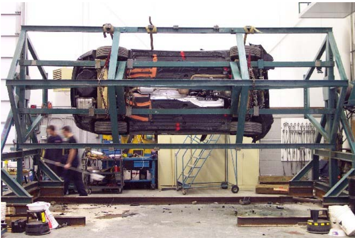
53. Vue du véhicule sur culbuteur à 270°. View of the vehicle on the roll over device at 270°.
