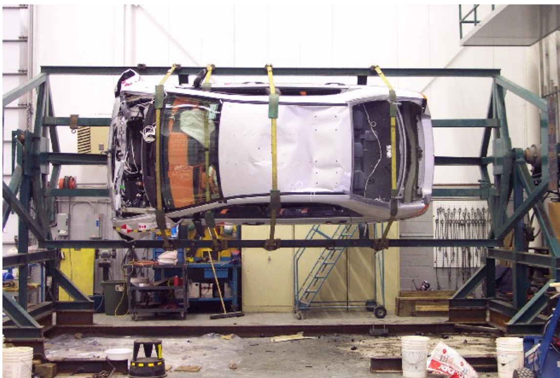
44. Vue du véhicule sur culbuteur à 90°. View of the vehicle on the roll over device at 90°.
