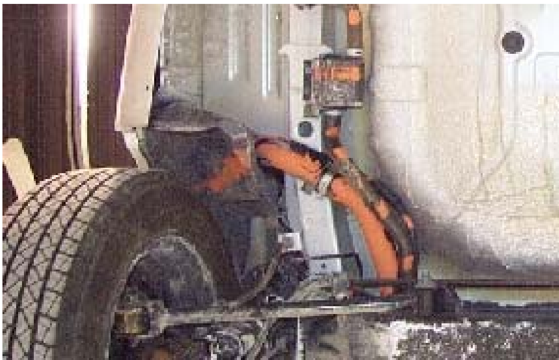
33. Tuyau de remplissage et vapeur. Filler and vapor pipe.
