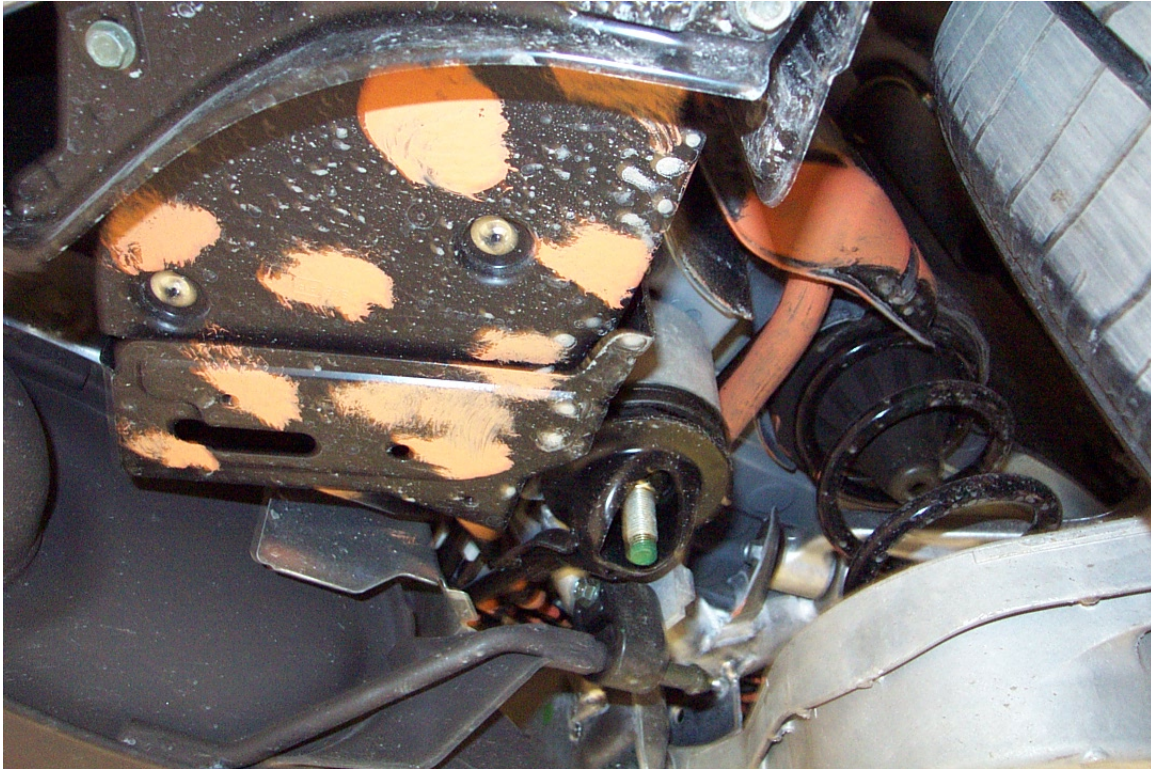
36. Tuyau de remplissage et vapeur. Filler and vapor pipe.
