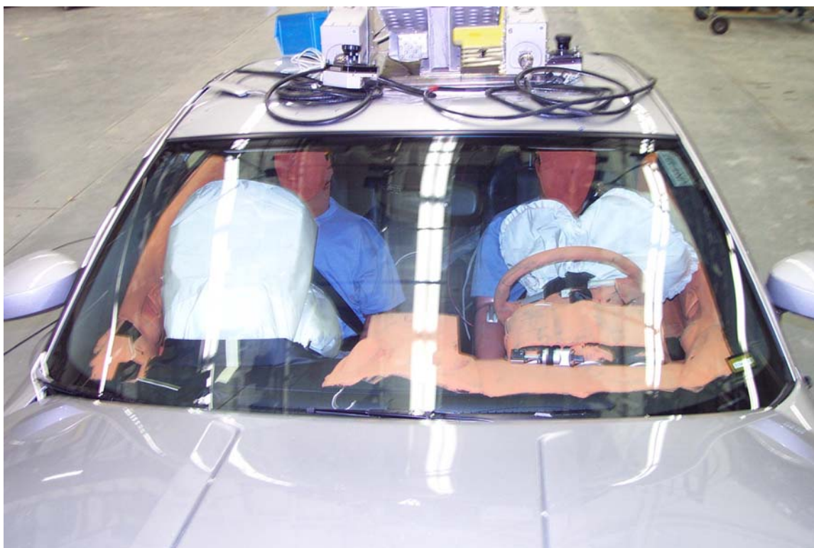
33. Pare-brise, après essai. Windshield, post-test.
