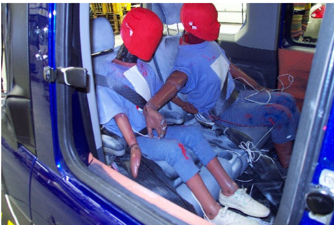
35. Position du passager arrière droit, vue ¾ droite, après essai. Rear right passenger's position, ¾ right side view, post-test.
