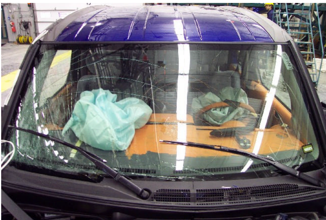
37. Pare-brise, après essai. Windshield, post-test.
