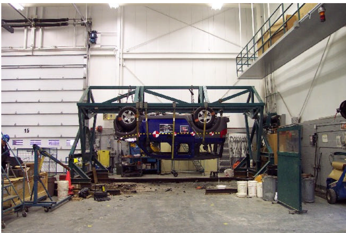
52. Vue du véhicule sur culbuteur à 180°. View of the vehicle on the roll over device at 180°.
