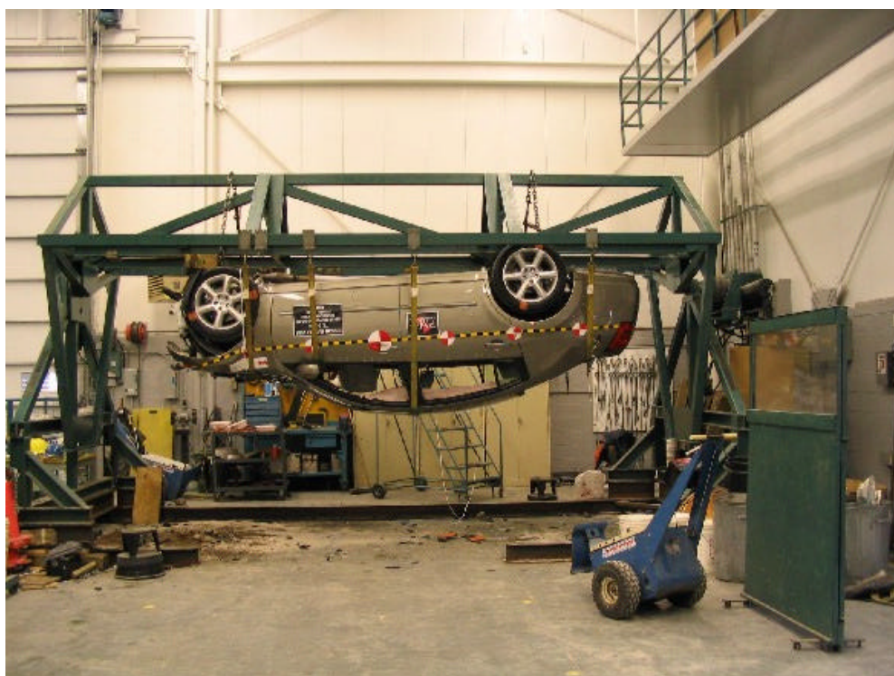
52. Vue du véhicule sur culbuteur à 180°. View of the vehicle on the roll over device at 180°.
