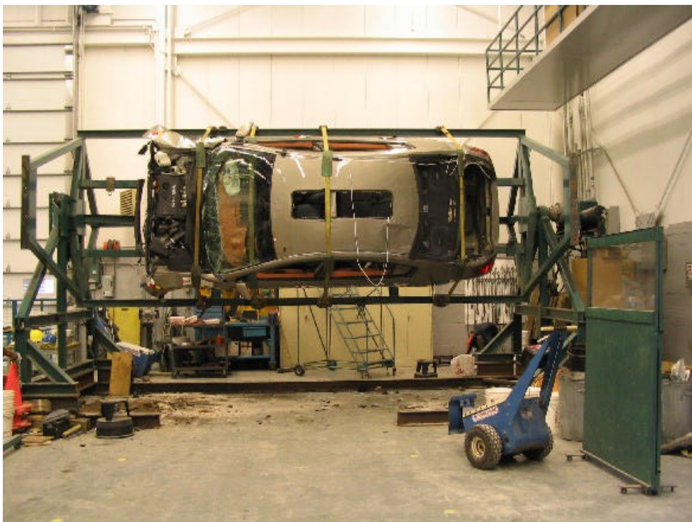
51. Vue du véhicule sur culbuteur à 90°. View of the vehicle on the roll over device at 90°.
