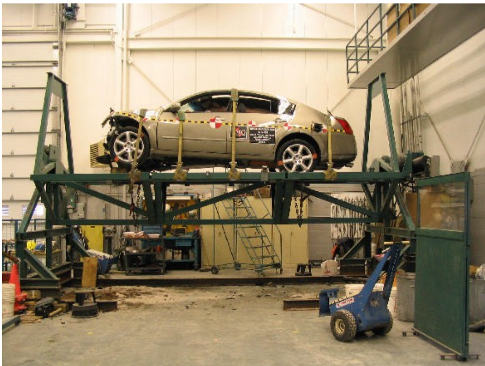
50. Vue du véhicule sur culbuteur avant l'essai de capotage statique. View of the vehicle on the roll over device before testing.
