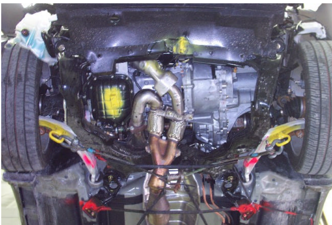
49. Vue du dessous du compartiment moteur, après essai. Under view of the engine compartment , post-test.
