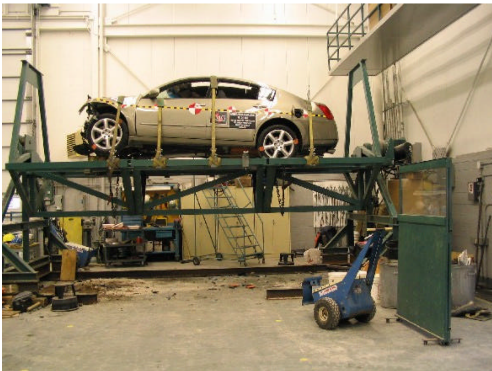
54. Vue du véhicule sur culbuteur à 360°. View of the vehicle on the roll over device at 360°.
