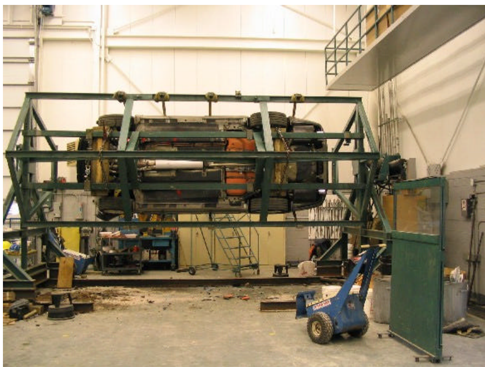
53. Vue du véhicule sur culbuteur à 270°. View of the vehicle on the roll over device at 270°.
