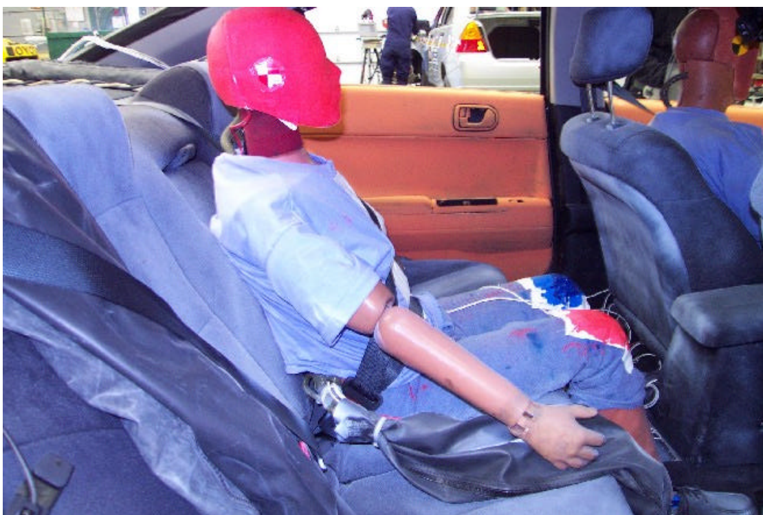
35. Position du passager arrière centre, vue de droite, après essai. Rear center passenger's position, right side view, post-test.
