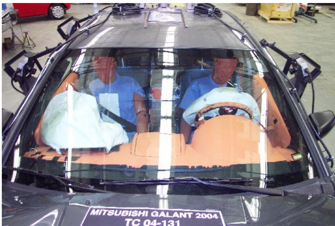
37. Pare-brise, après essai. Windshield, post-test.
