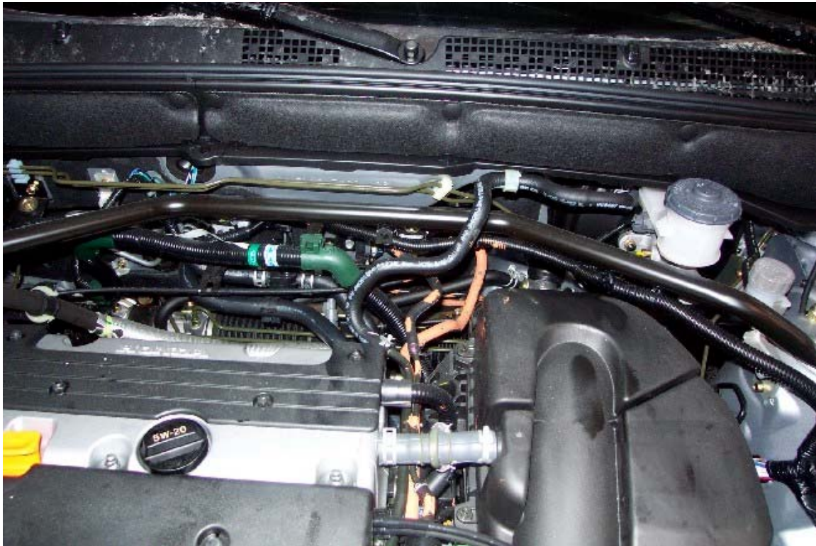
35. Lignes de carburant et vapeur dans le compartiment moteur. Filler and vapor lines in the engine compartment.
