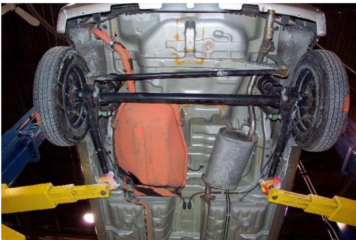
37. Réservoir de carburant. Fuel tank.
