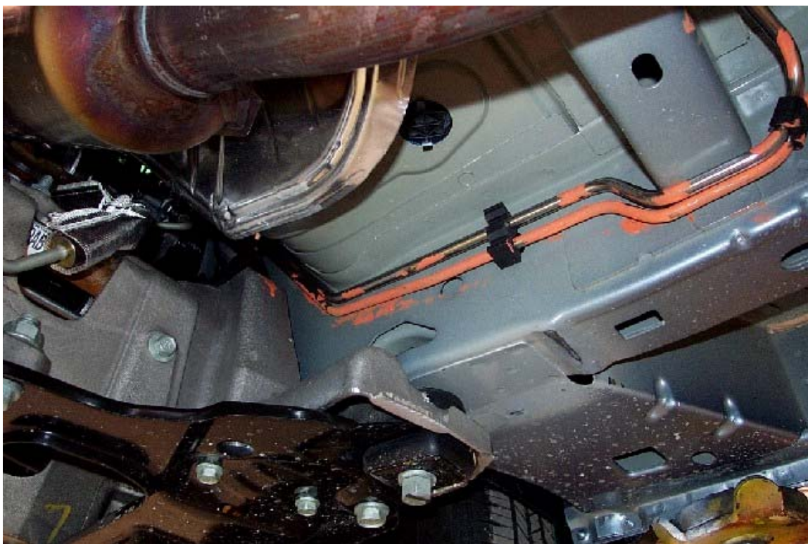
43. Lignes de carburant et vapeur. Fuel and vapor lines.
