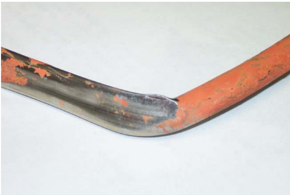
55. Vue de la fissure dans la conduite d'alimentation de carburant. View of the crack in the supply line.
