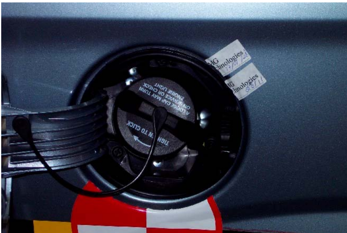
39. Bouchon de remplissage, après essai. Filler cap, post-test.
