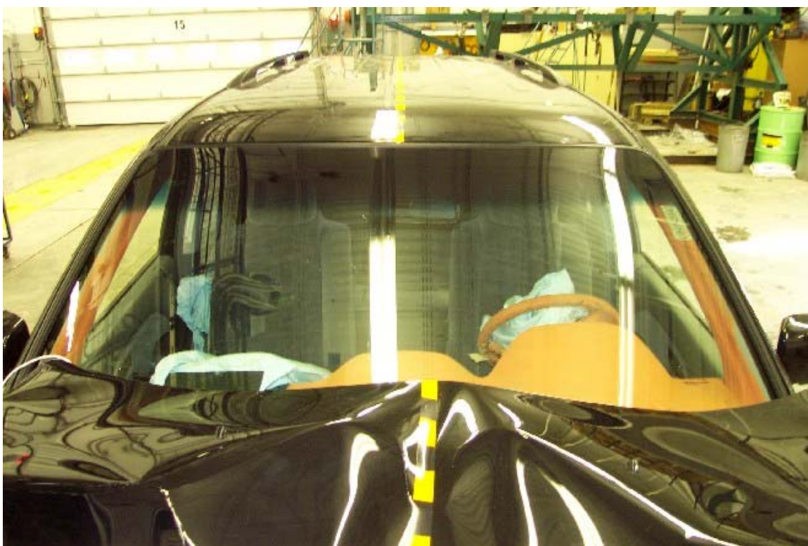
33. Pare-brise, après essai. Windshield, post-test.
