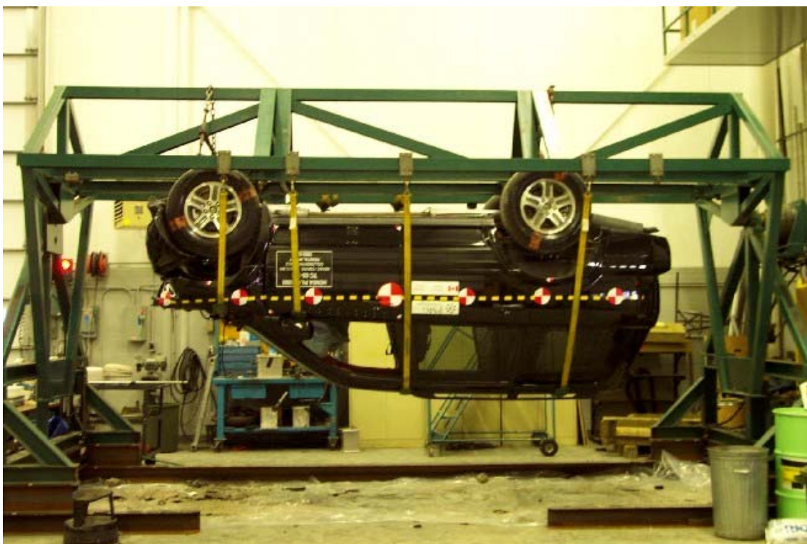
48. Vue du véhicule sur culbuteur à 180°. View of the vehicle on the roll over device at 180°.
