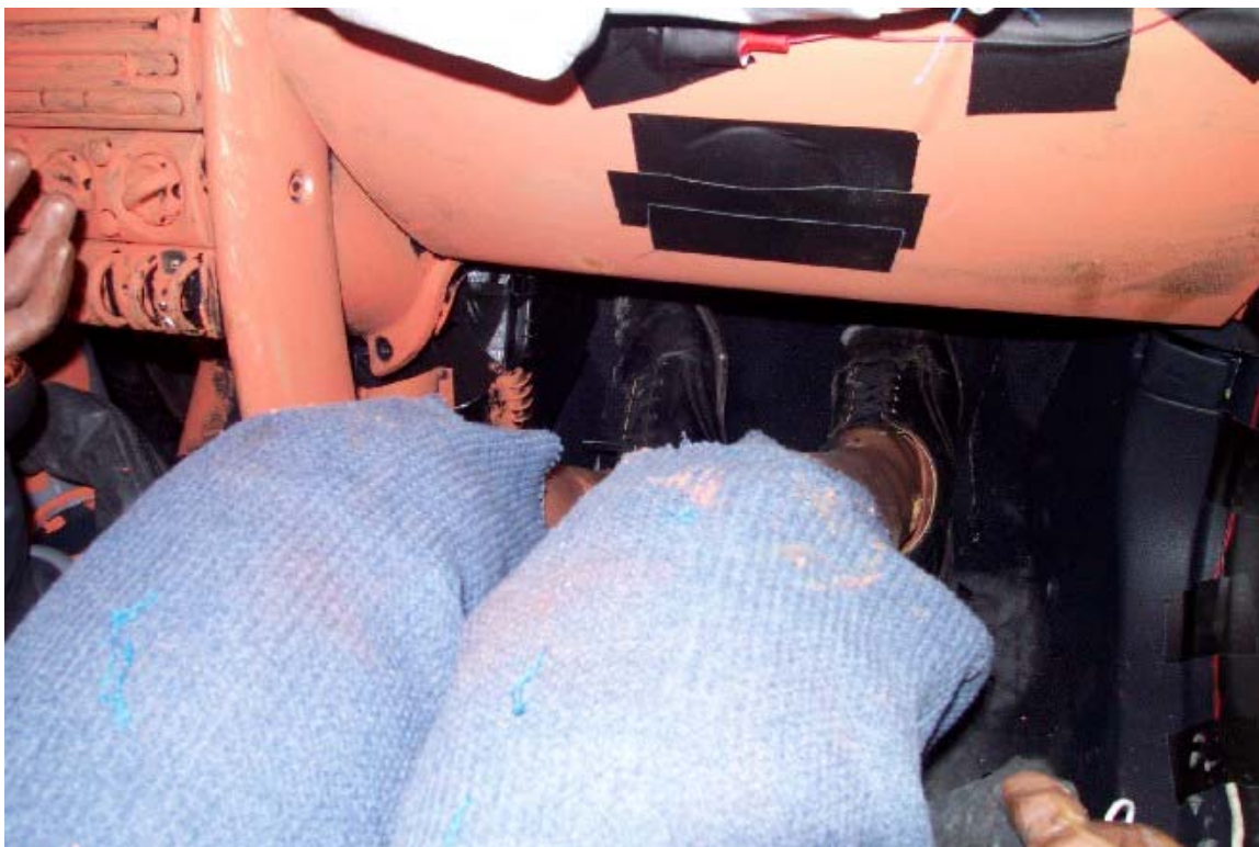
30. Point de contact des genoux du passager, après essai. Passenger's knees contact point, post-test.
