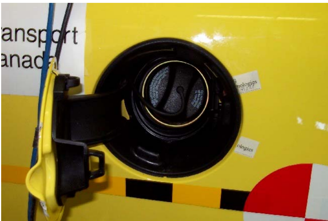
34. Bouchon de remplissage, après essai. Filler cap, post-test.
