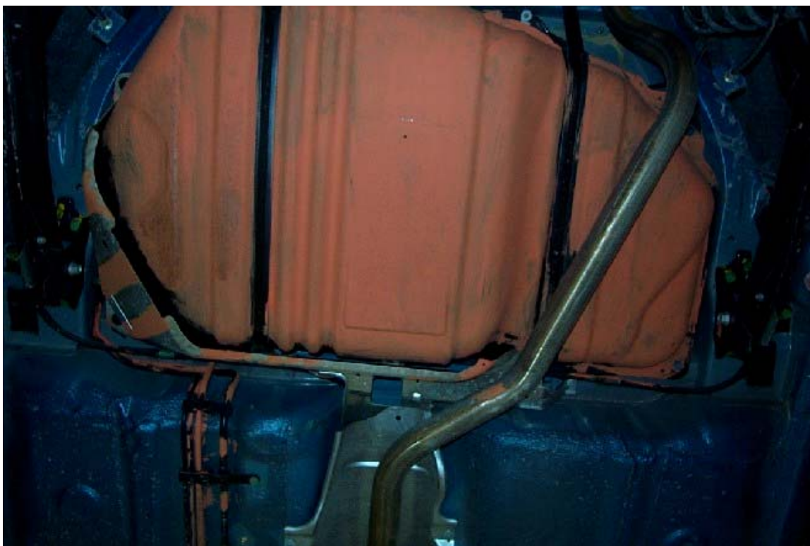
37. Réservoir de carburant. Fuel tank.
