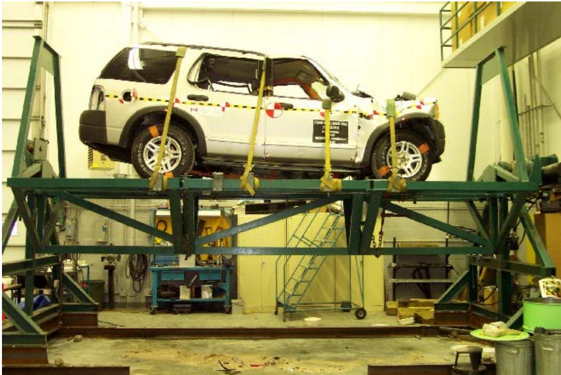
45. Vue du véhicule sur culbuteur avant l'essai de capotage statique. View of the vehicle on the roll over device before testing.
