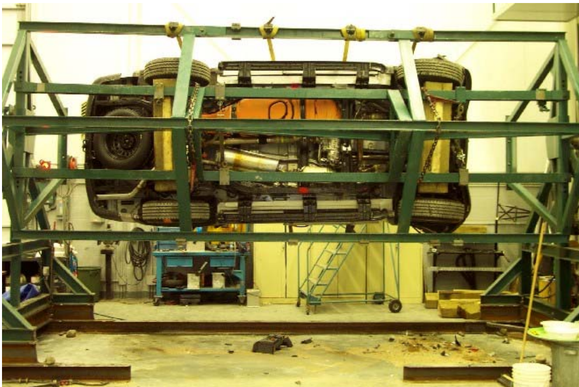
48. Vue du véhicule sur culbuteur à 270°. View of the vehicle on the roll over device at 270°.
