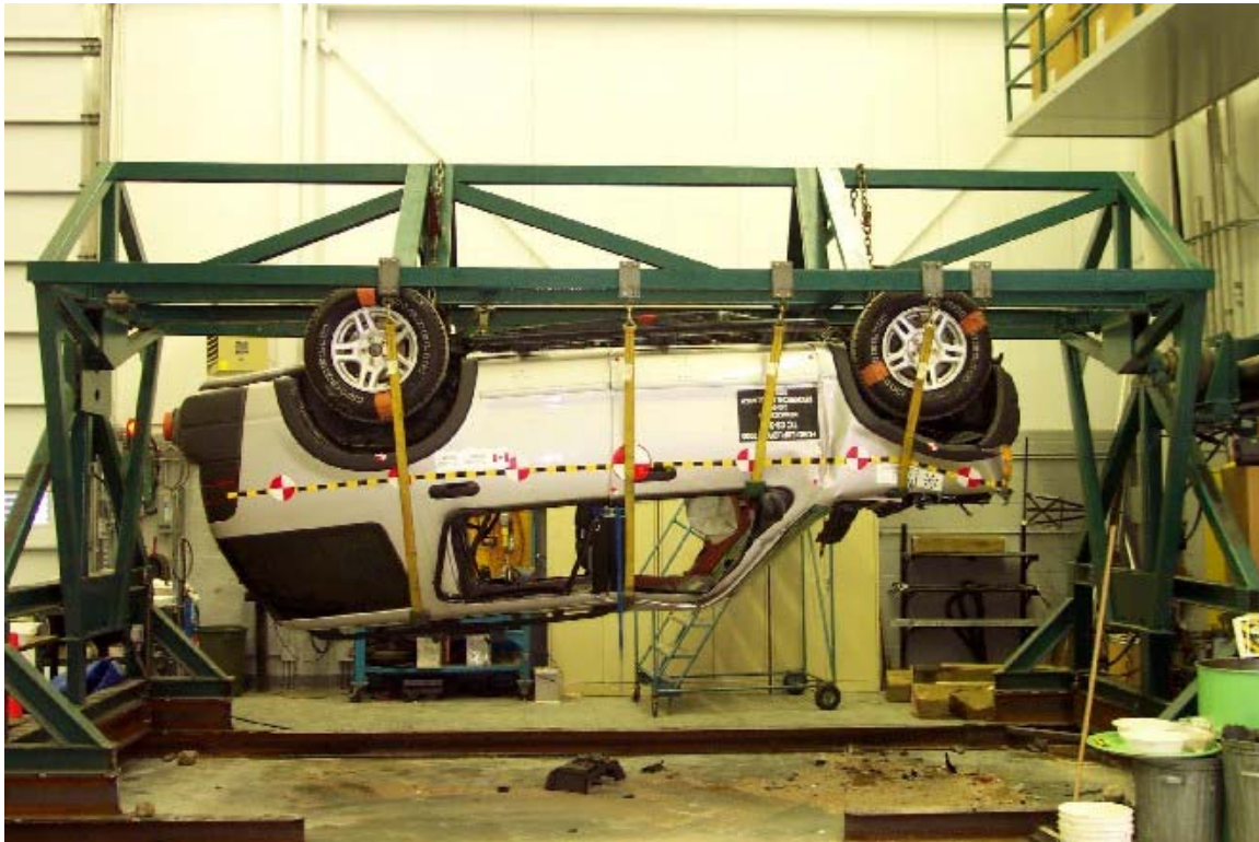
47. Vue du véhicule sur culbuteur à 180°. View of the vehicle on the roll over device at 180°.
