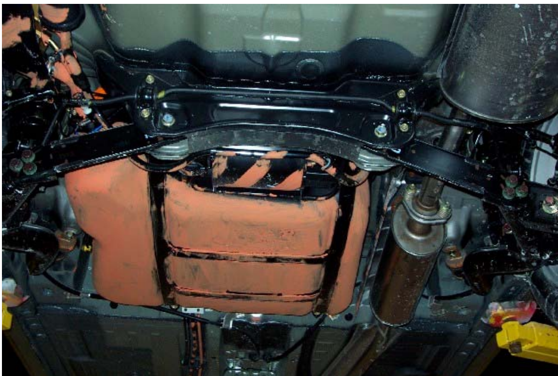
34. Réservoir de carburant. Fuel tank.
