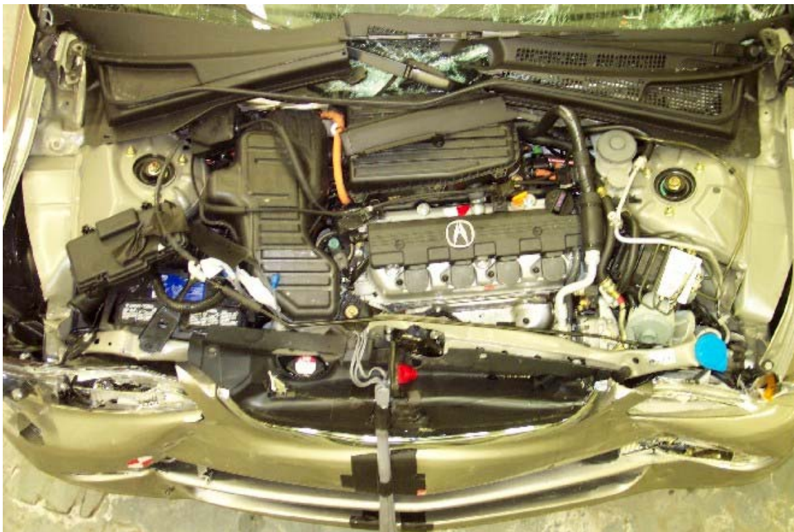
40. Vue du compartiment moteur du véhicule d'essai, après essai. Engine compartment view of the vehicle, post-test.
