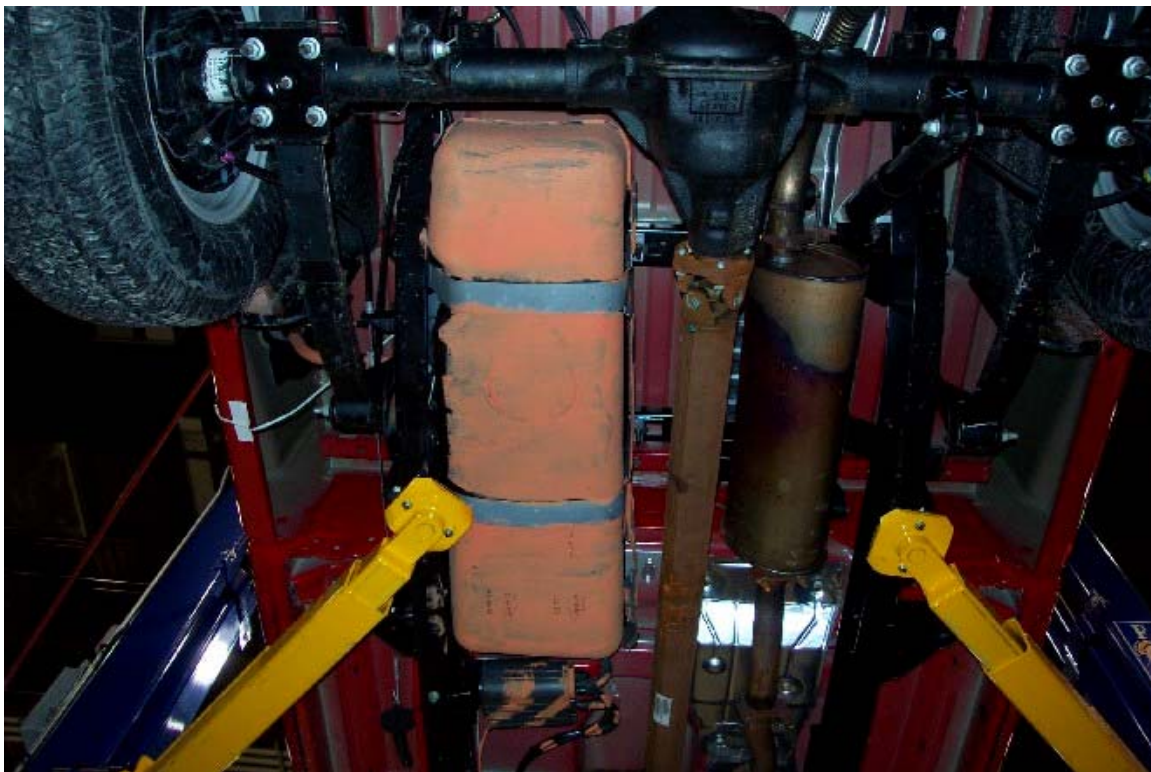
30. Réservoir de carburant. Fuel tank.
