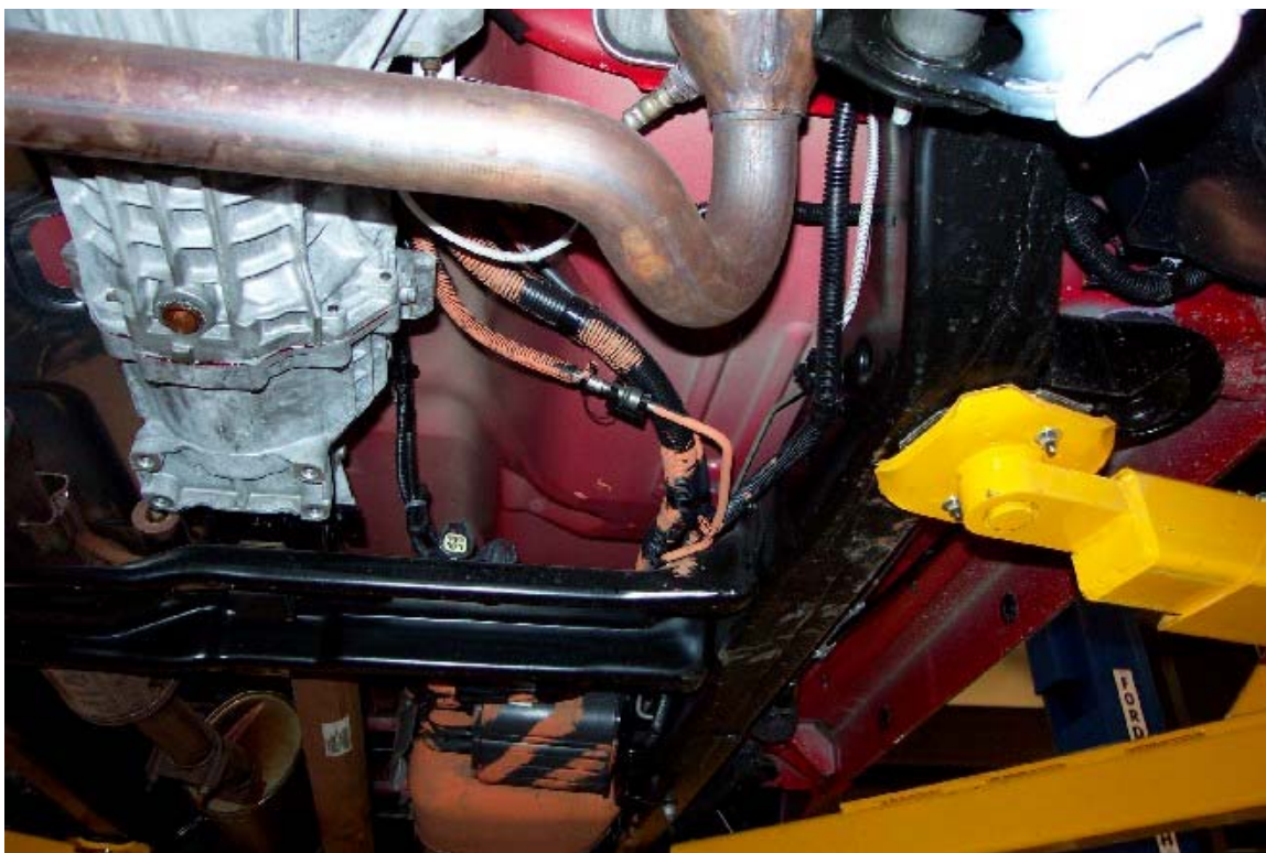
32. Lignes de carburant et vapeur. Fuel and vapor lines.
