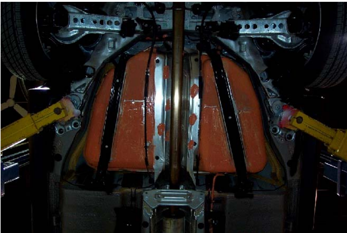
34. Réservoir de carburant. Fuel tank.
