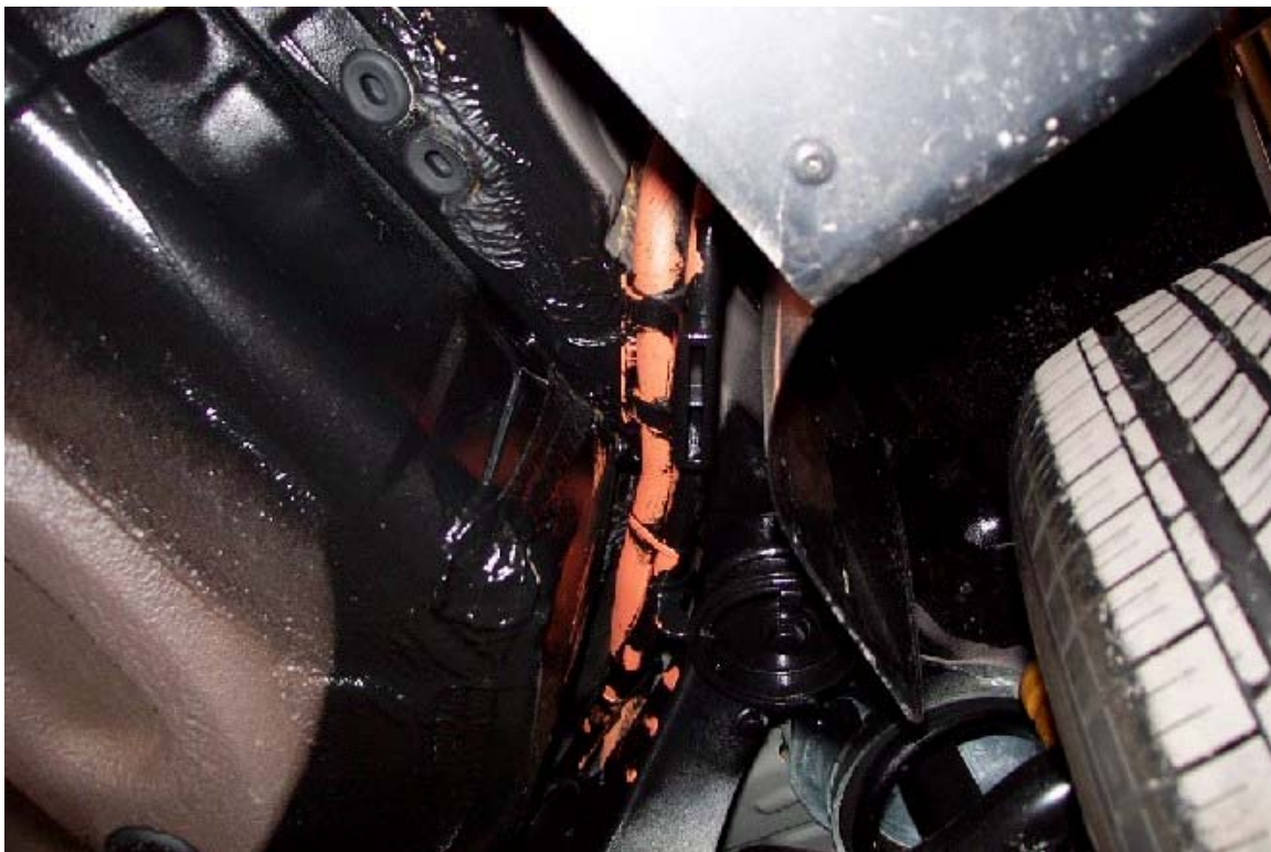
36. Lignes de carburant et vapeur. Fuel and vapor lines.
