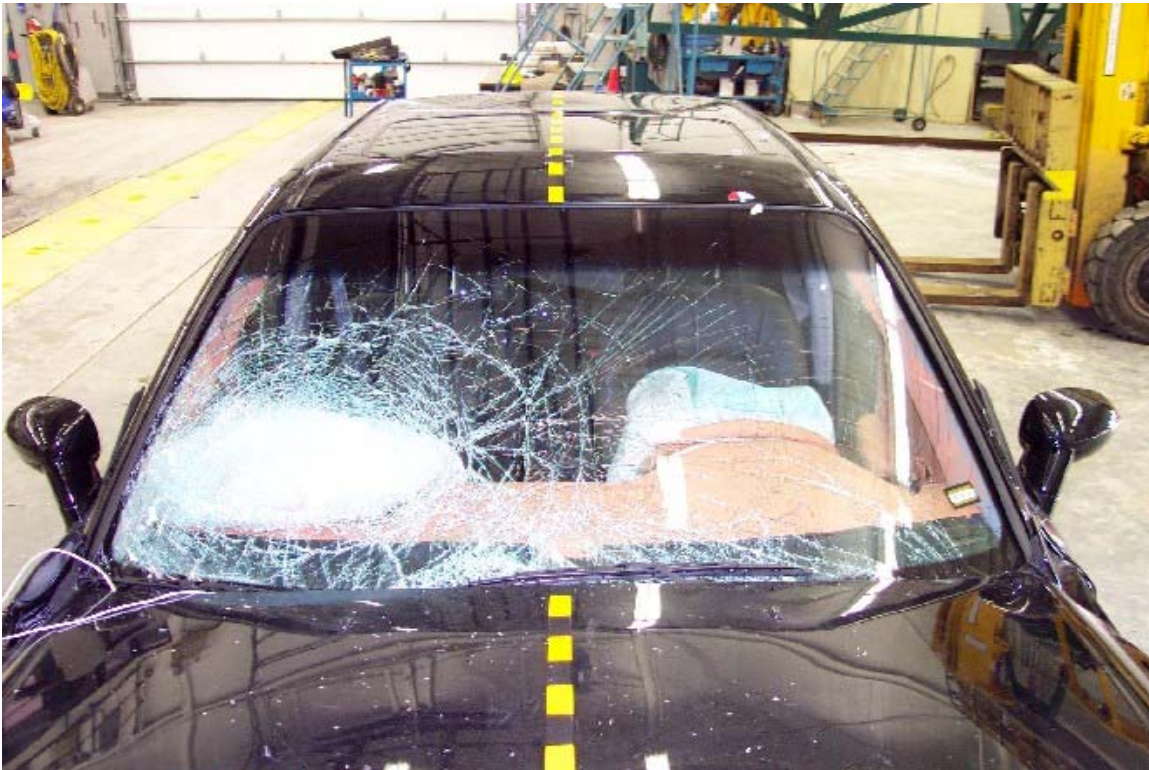
33. Pare-brise, après essai. Windshield, post-test.
