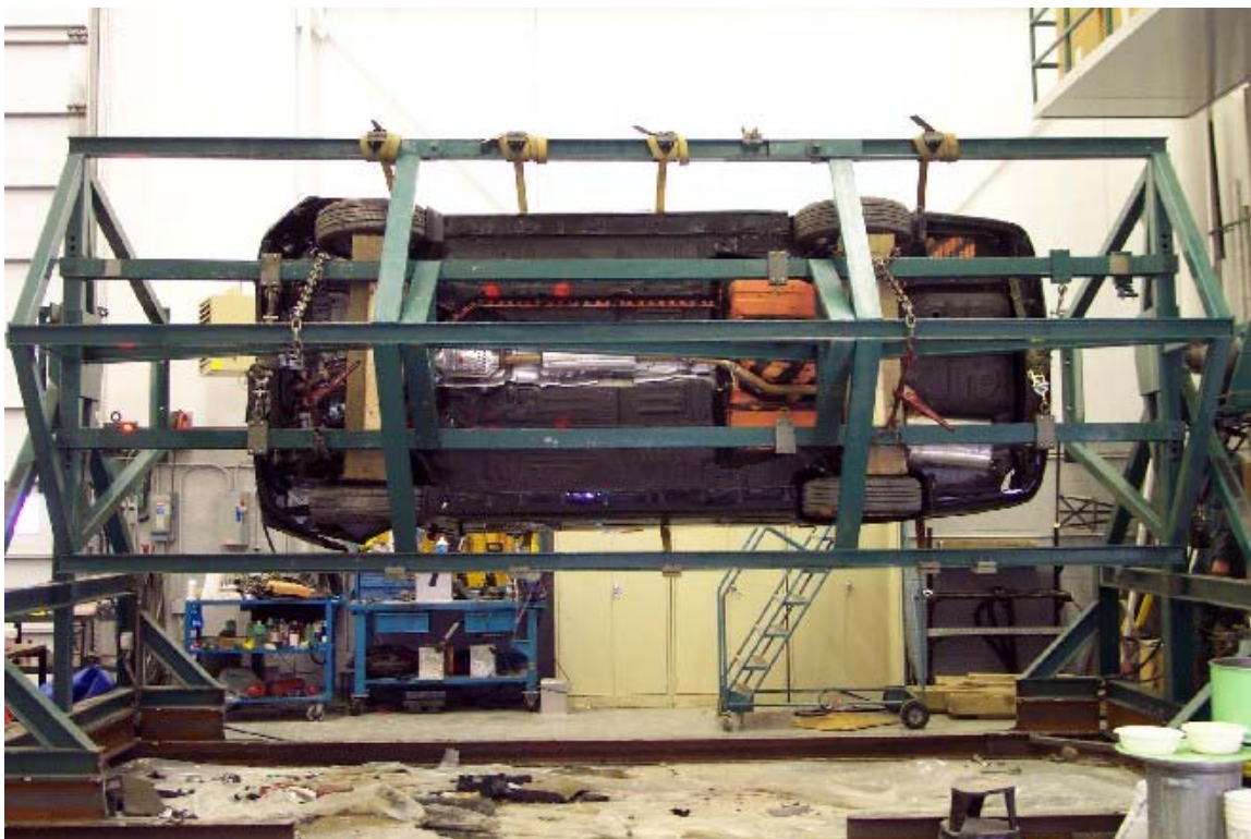
49. Vue du véhicule sur culbuteur à 270°. View of the vehicle on the roll over device at 270°.
