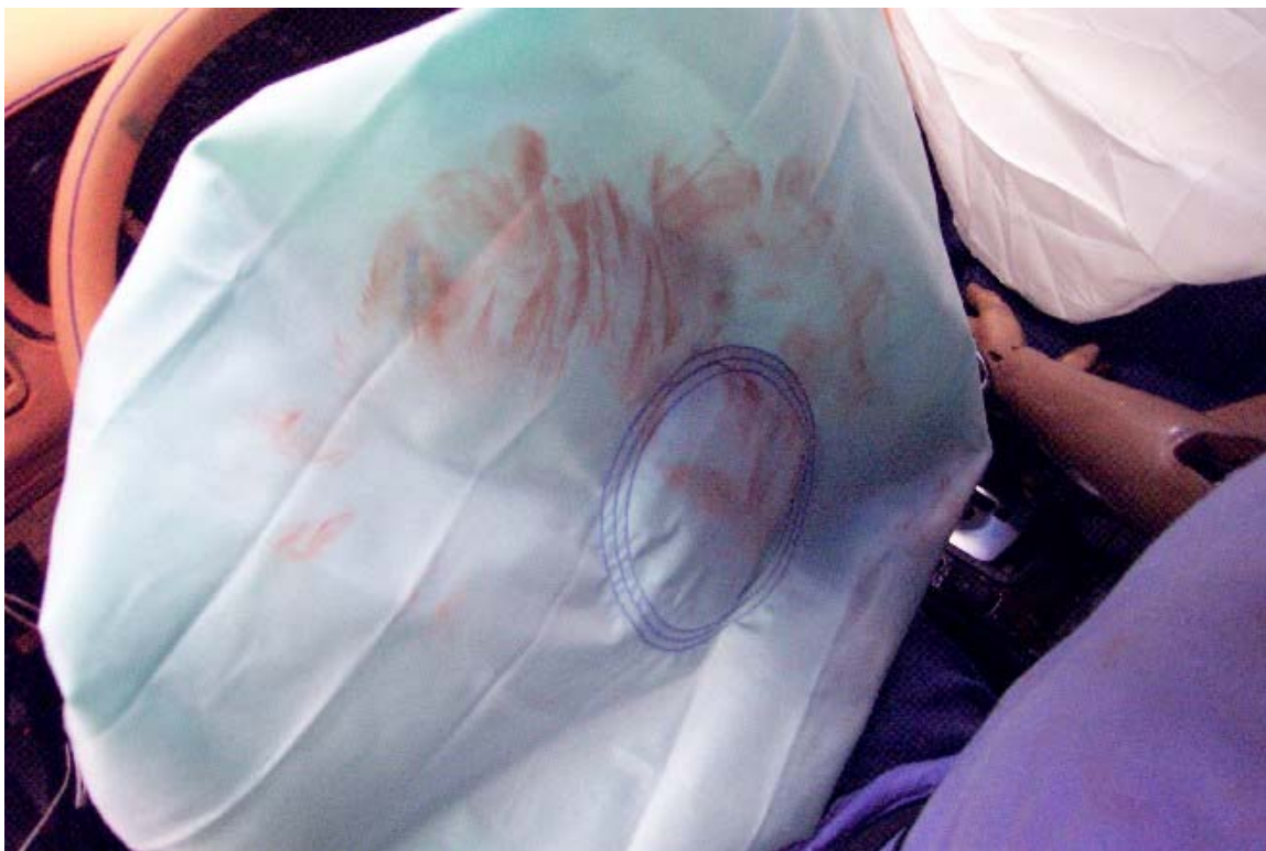
23. Point de contact de tête du conducteur, après essai. Driver's head contact point, post-test.
