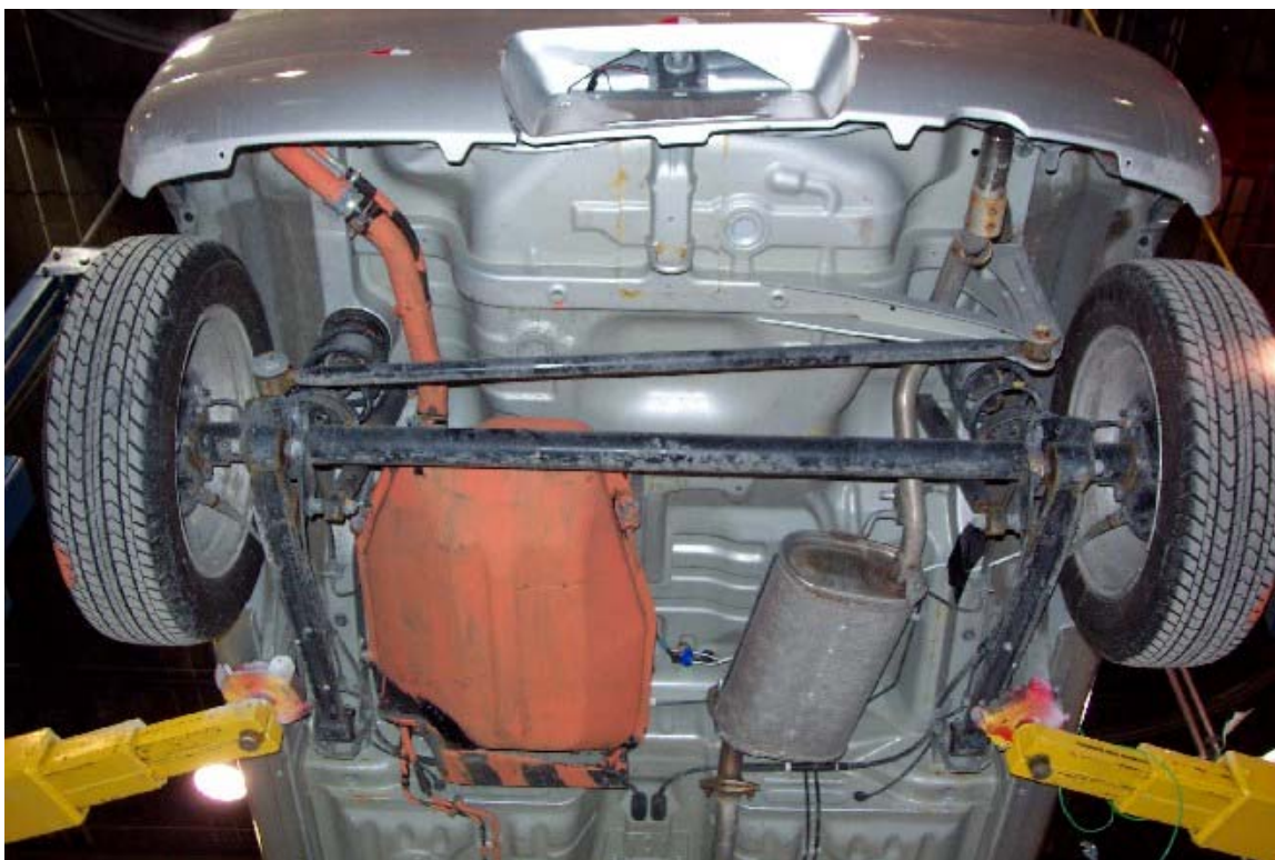
36. Réservoir de carburant. Fuel tank.
