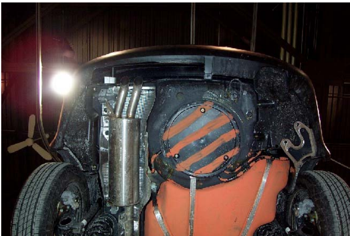
37. Réservoir de carburant. Fuel tank.
