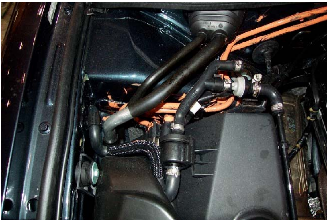
40. Lignes de carburant et vapeur dans le compartiment moteur. Filler and vapor lines in the engine compartment.
