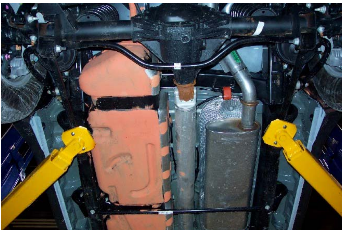
37. Réservoir de carburant. Fuel tank.
