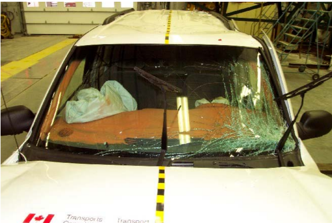
33. Pare-brise, après essai. Windshield, post-test.
