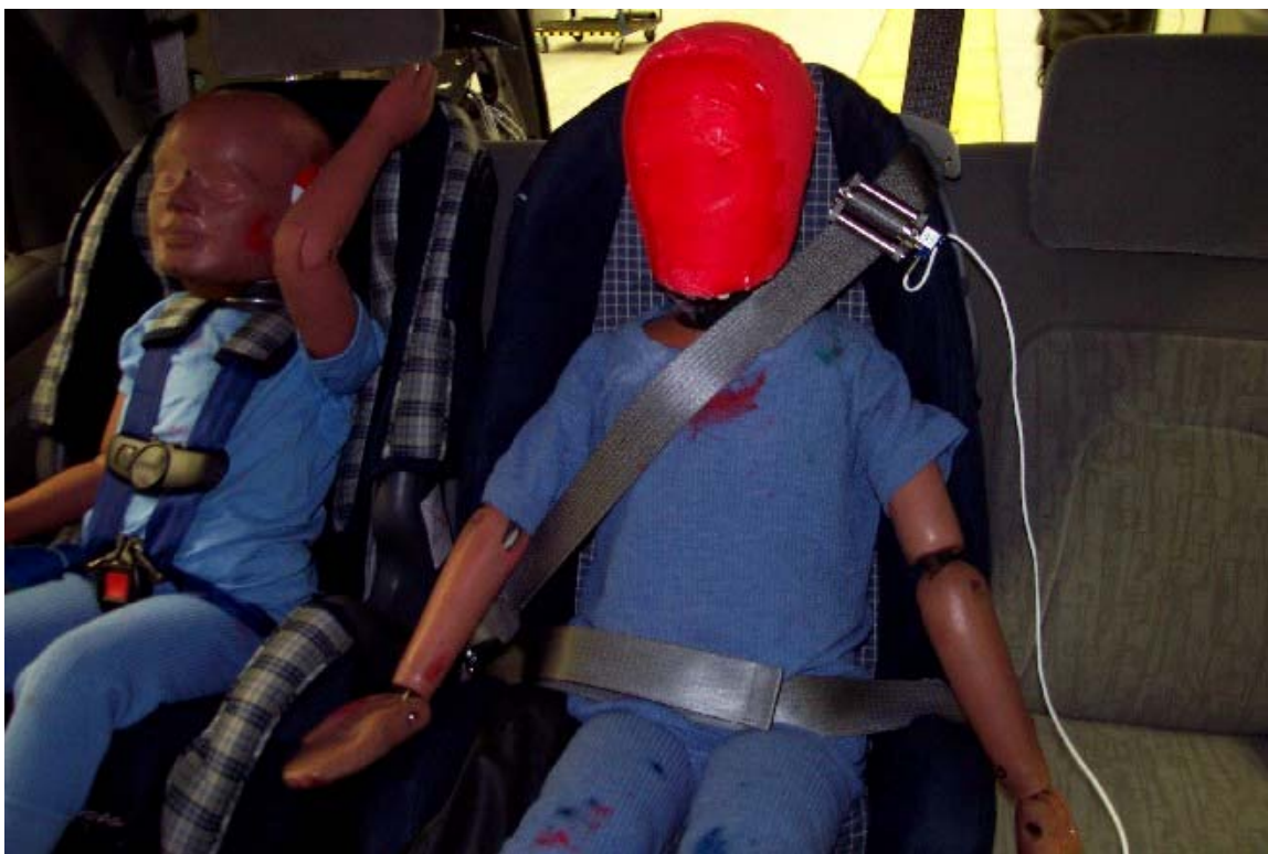
39. Position du passager arrière centre, après essai. Rear center passenger's position, post-test.
