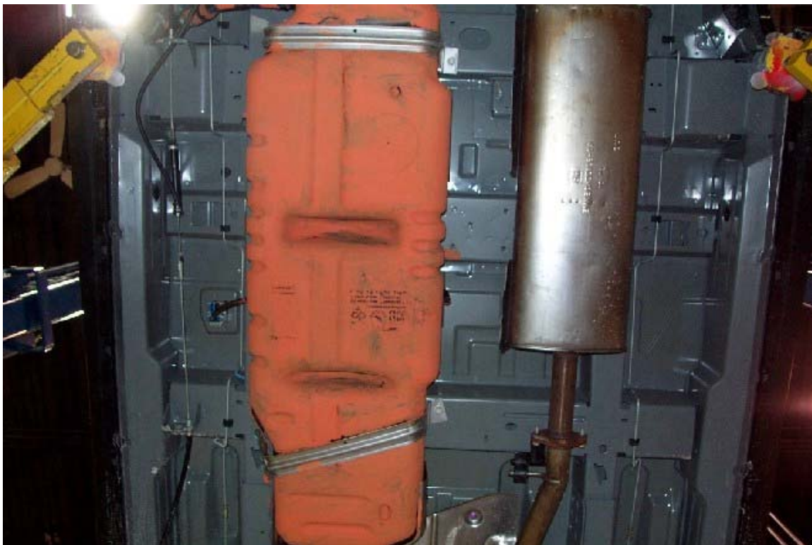
34. Réservoir de carburant. Fuel tank.
