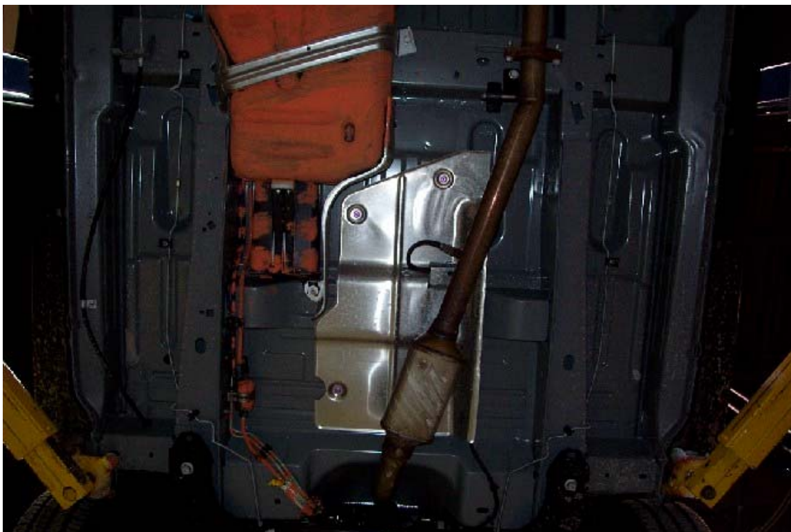
40. Ligne de carburant et vapeur. Fuel and vapor lines.
