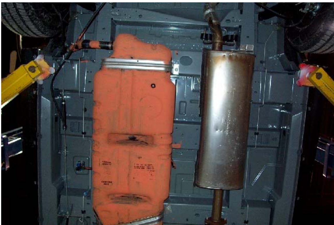
39. Réservoir de carburant. Fuel tank.
