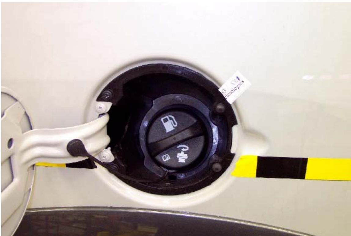
36. Bouchon de remplissage, avant essai. Filler cap, pre-test.
