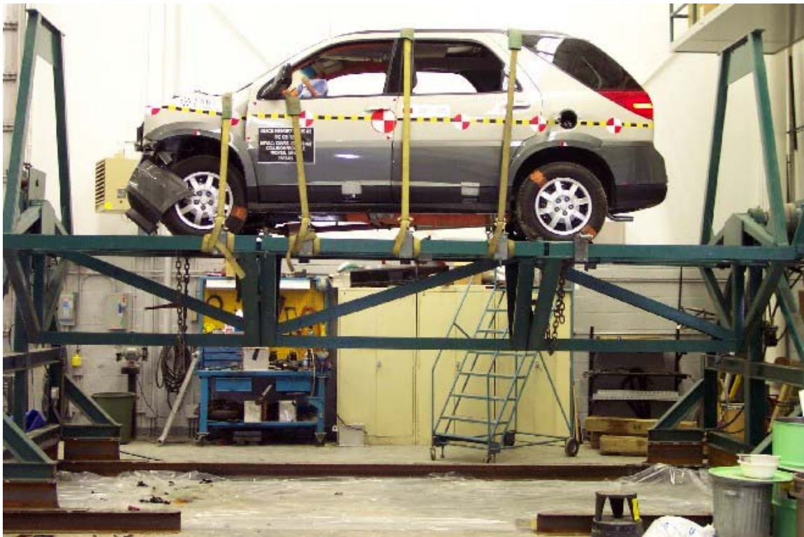
48. Vue du véhicule sur culbuteur avant l'essai de capotage statique. View of the vehicle on the roll over device before testing.
