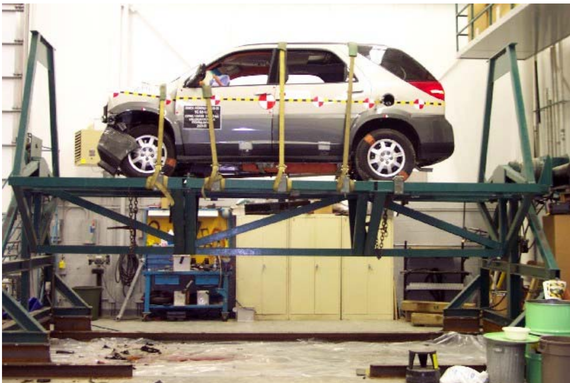
52. Vue du véhicule sur culbuteur à 360°. View of the vehicle on the roll over device at 360°.
