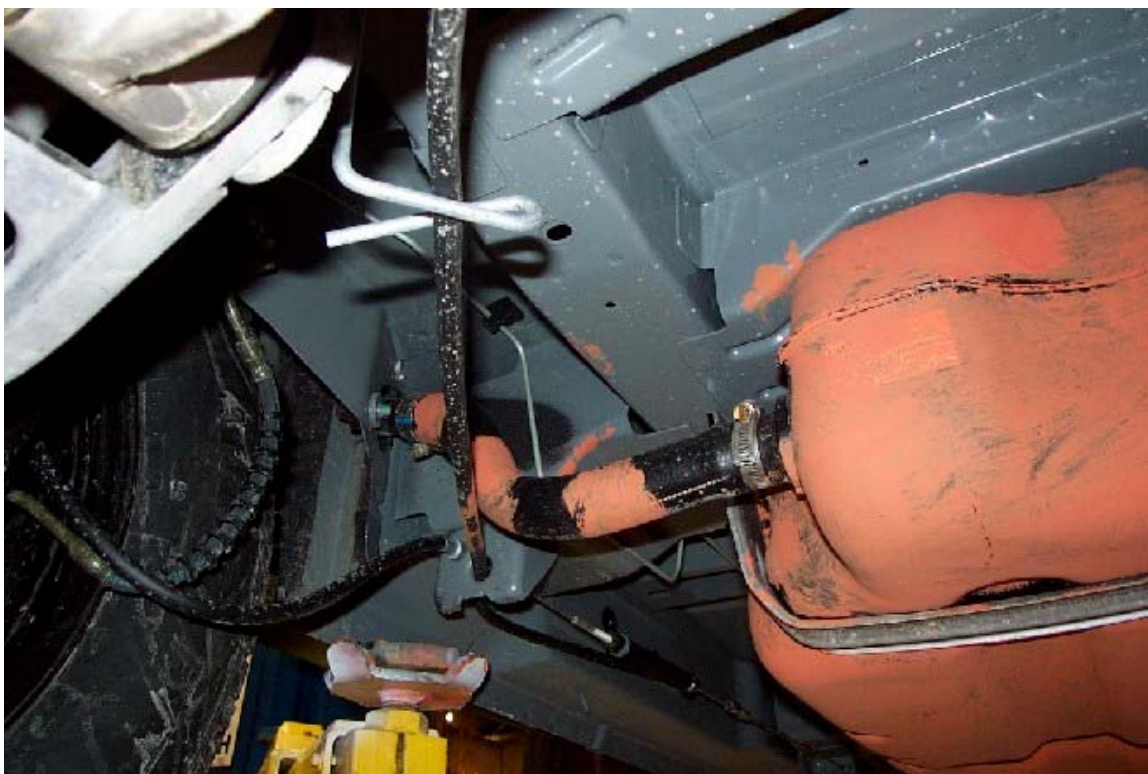
41. Lignes de carburant et vapeur. Fuel and vapor lines.
