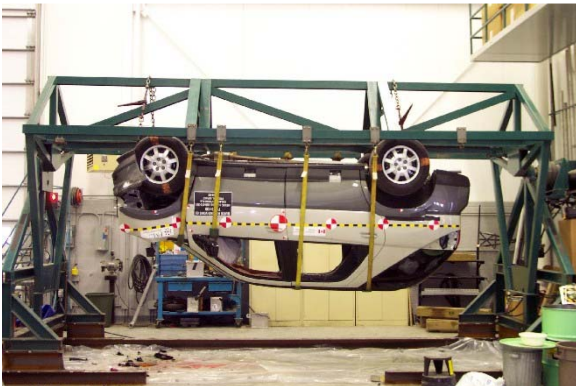
50. Vue du véhicule sur culbuteur à 180°. View of the vehicle on the roll over device at 180°.
