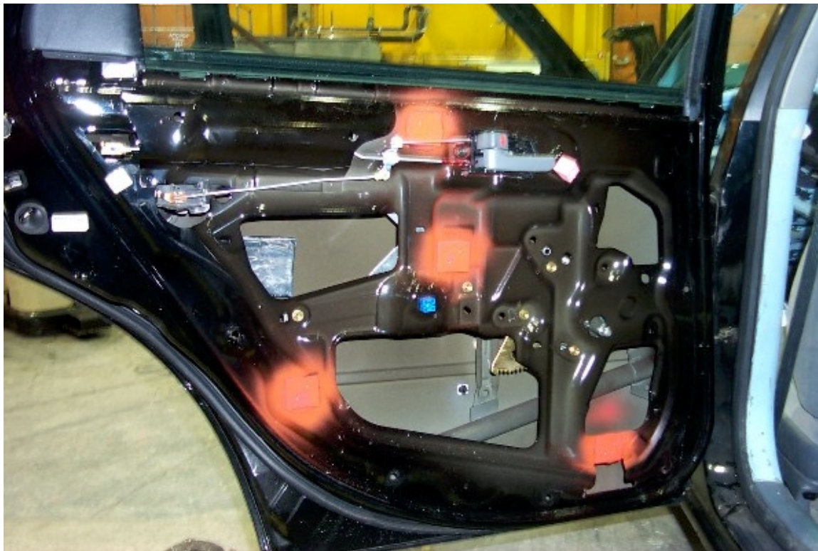
36. Mousse de protection à l'intérieur de la porte arrière gauche. Protective foam inside left rear door.
