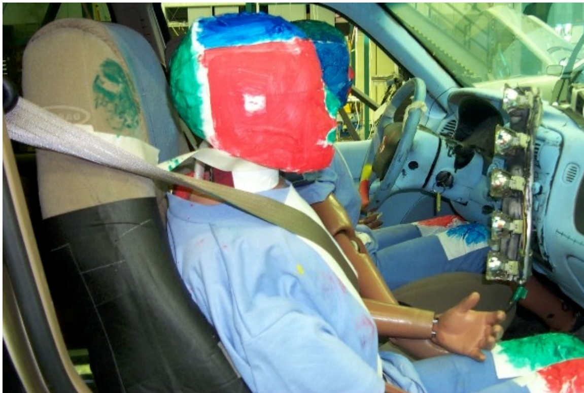
63. Point de contact de tête du passager, véhicule bélier, après essai. Passenger's head contact point, bullet vehicle, post-test.
