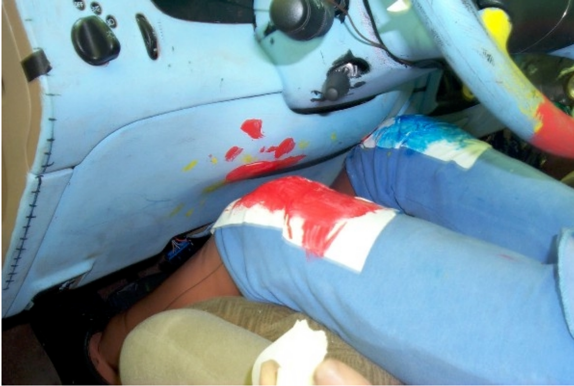
59. Point de contact des genoux du conducteur, véhicule bélière, après essai. Driver's knees contact points, bullet vehicle, post-test.
