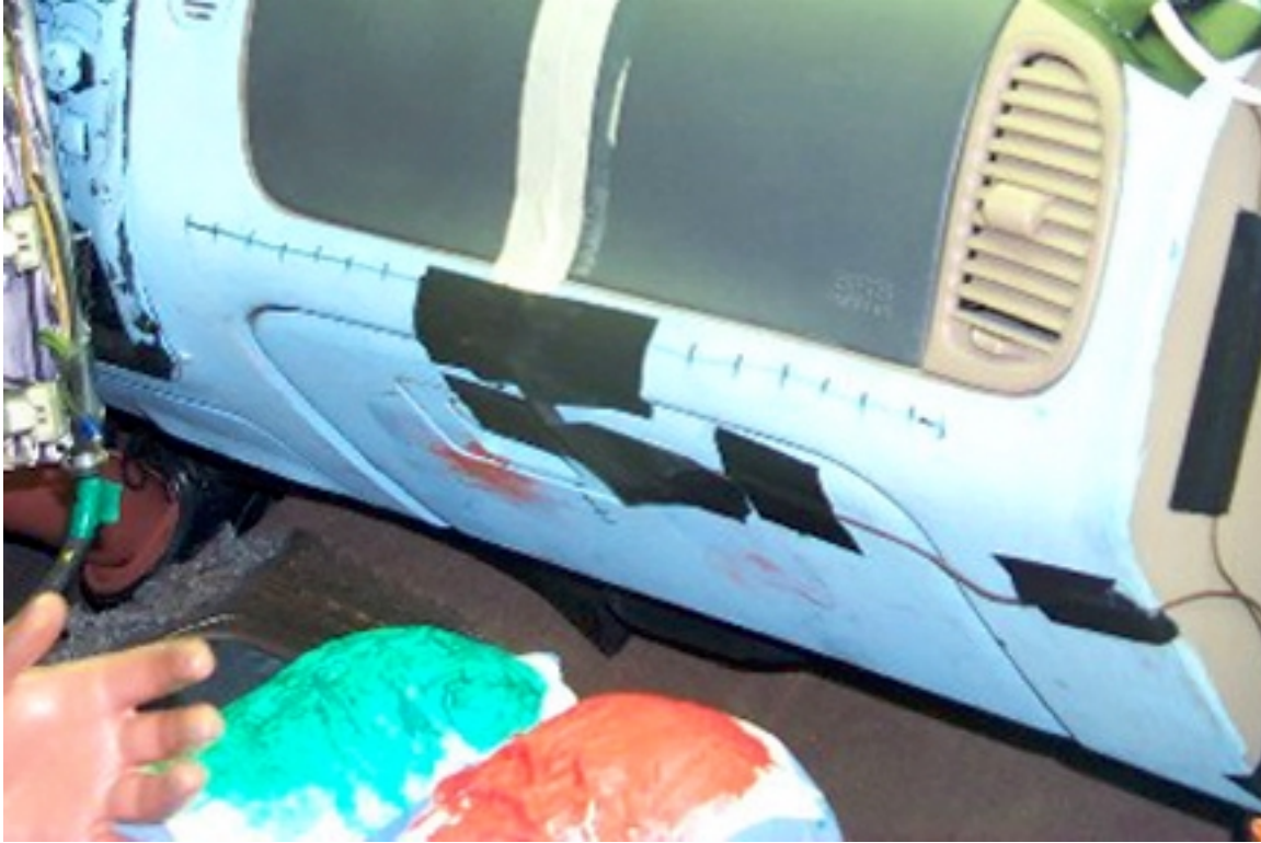
64. Point de contact des genoux du passager, véhicule bélière, après essai. Passenger's knees contact points, bullet vehicle, post-test.
