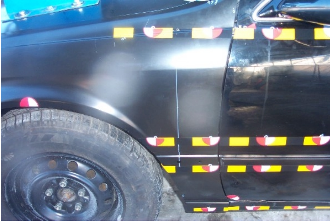
25. Point d'impact sur véhicule cible, avant essai. Impact point on target vehicle, pre-test.
