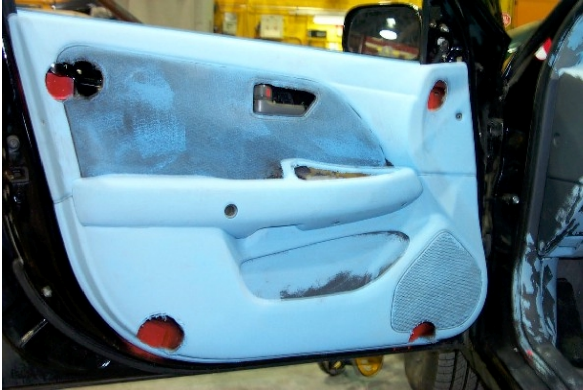
37. Position des accéléromètres dans la porte avant gauche. Position of accelerometers in front left door.
