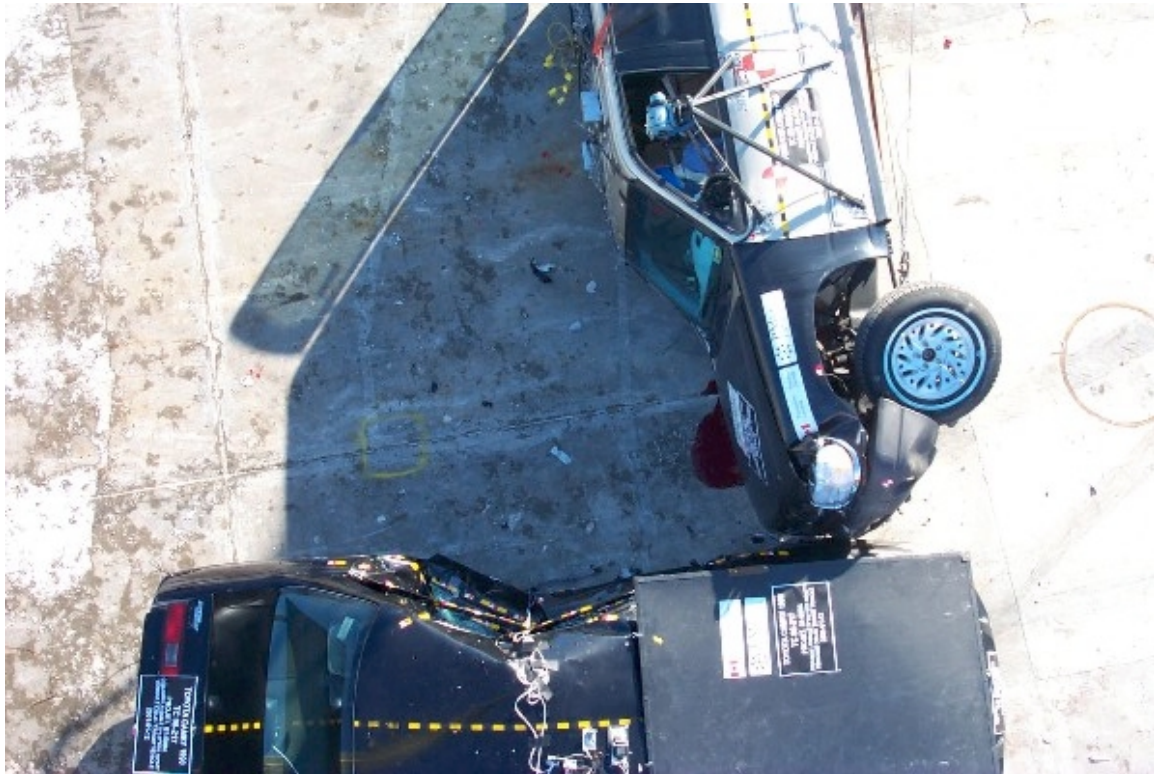
32. Vue de plan des véhicules en contact, après essai. Top view of vehicles in contact, post-test.
