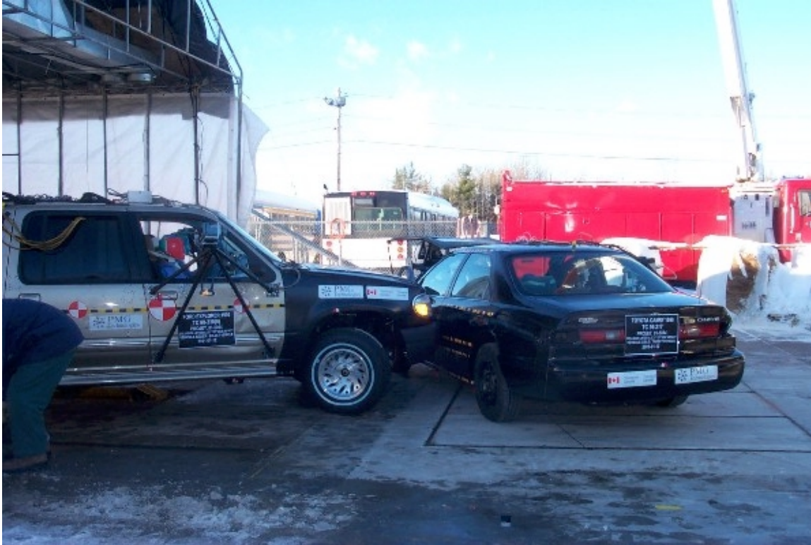
29. Vue ¾ arrière des véhicules en contact, avant essai. ¾ rear view of vehicles in contact, pre-test.
