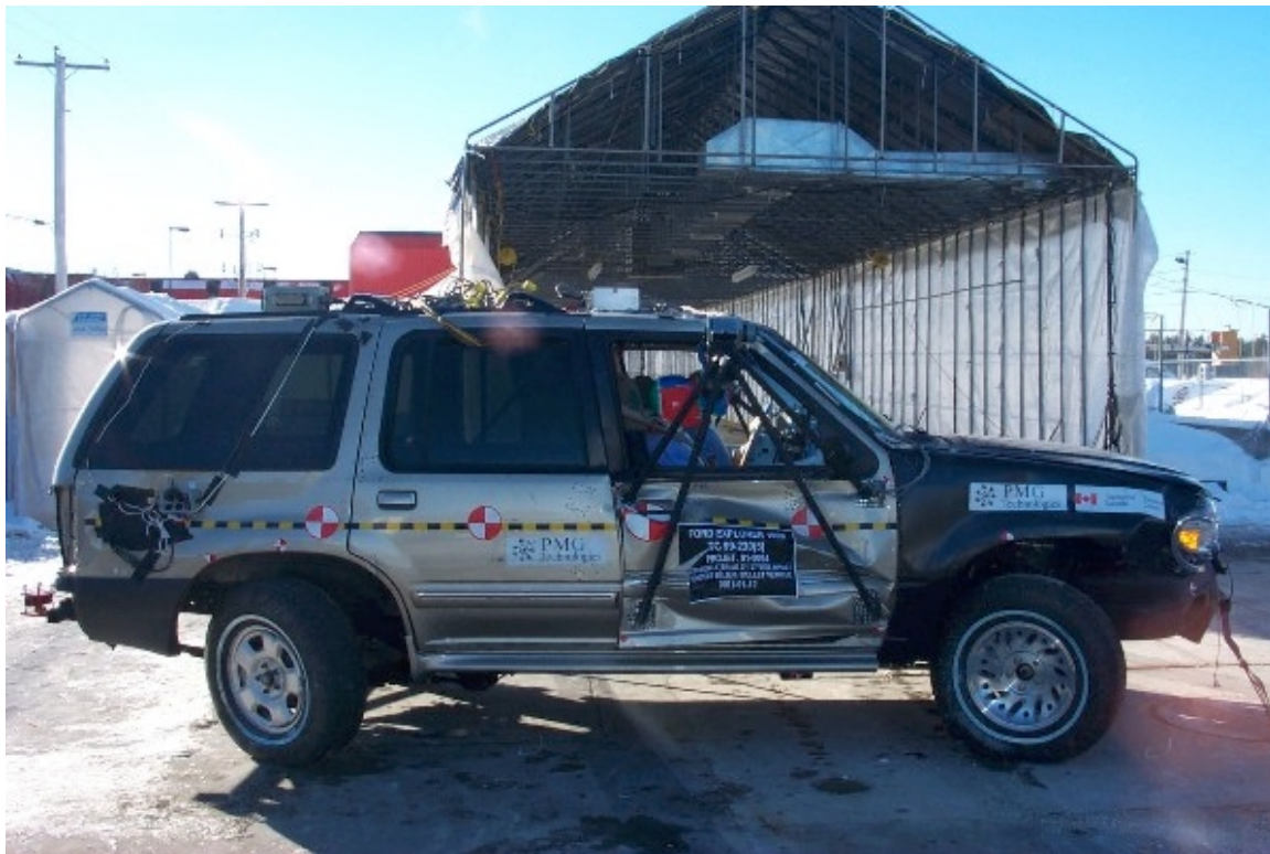
6. Vue générale côté droit du véhicule bélière, après essai. General right side view of bullet vehicle, post-test.
