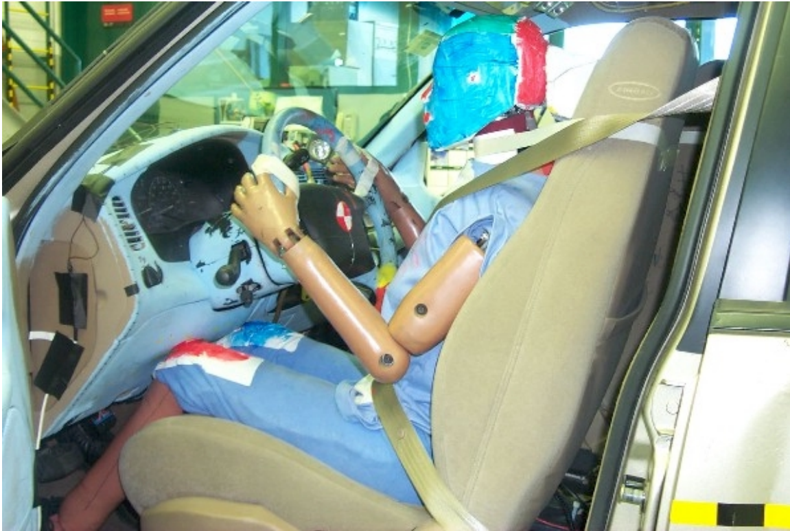
55. Position du conducteur, véhicule bélier, avant essai. Driver's position, bullet vehicle, pre-test.
