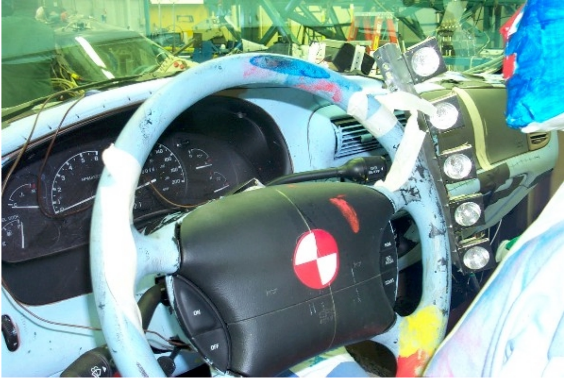
57. Point de contact de tête du conducteur, véhicule bélière, après essai. Driver's head contact point, bullet vehicle, post-test.
