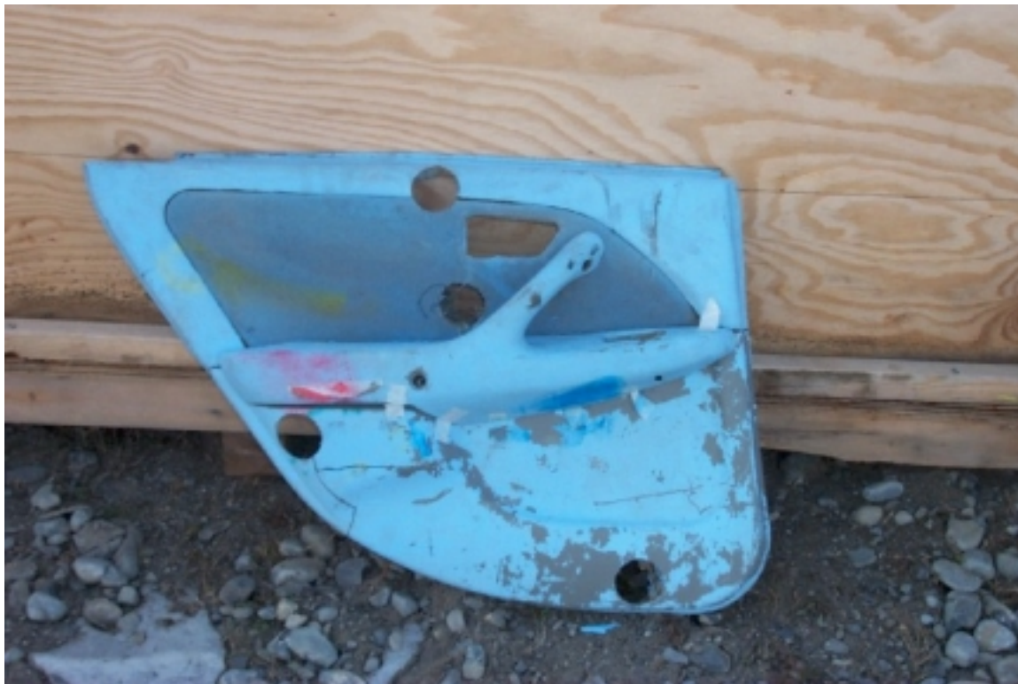
54. Points de contact sur l'intérieur de la portière arrière gauche, après essai. Contact points on the inside of the left rear door trim, post-test .
