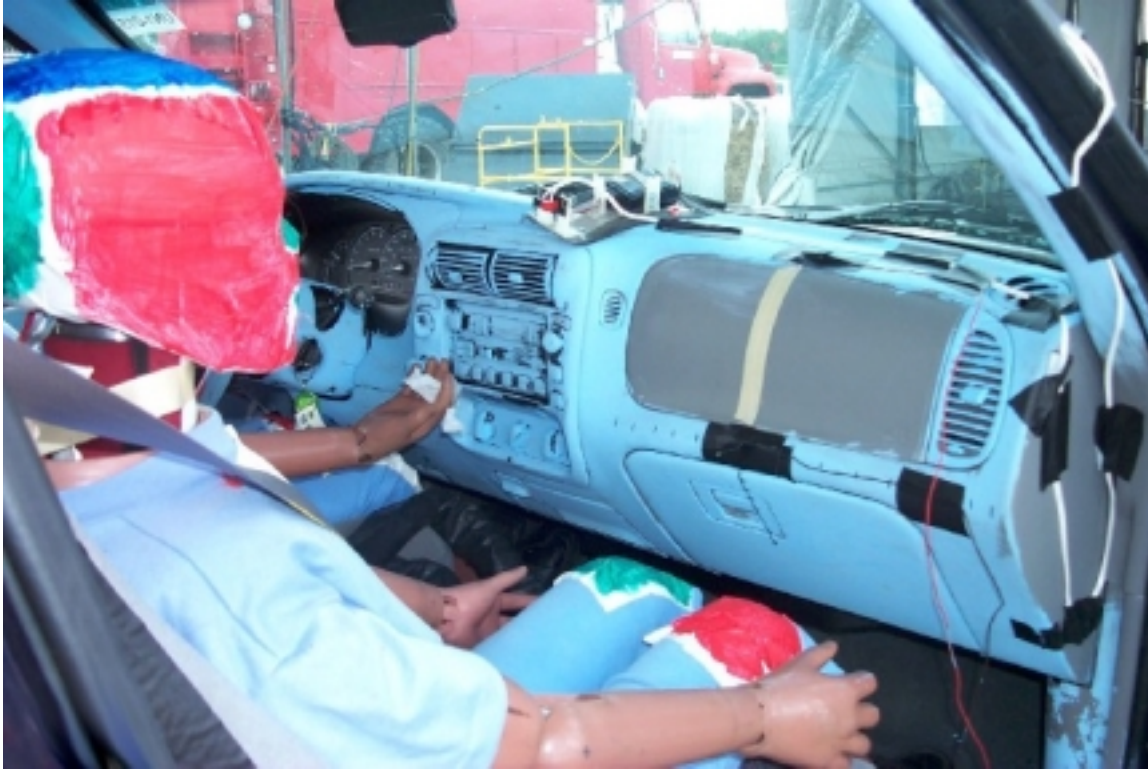
62. Point de contact de tête du passager, véhicule bélière, après essai. Passenger's head contact point, bullet vehicle, post-test.
