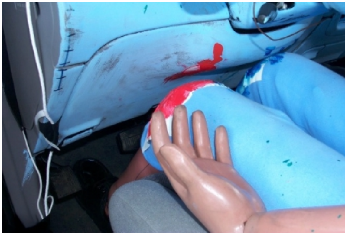
59. Point de contact des genoux du conducteur, véhicule béliier, après essai. Driver's knees contact points, bullet vehicle, post-test.
