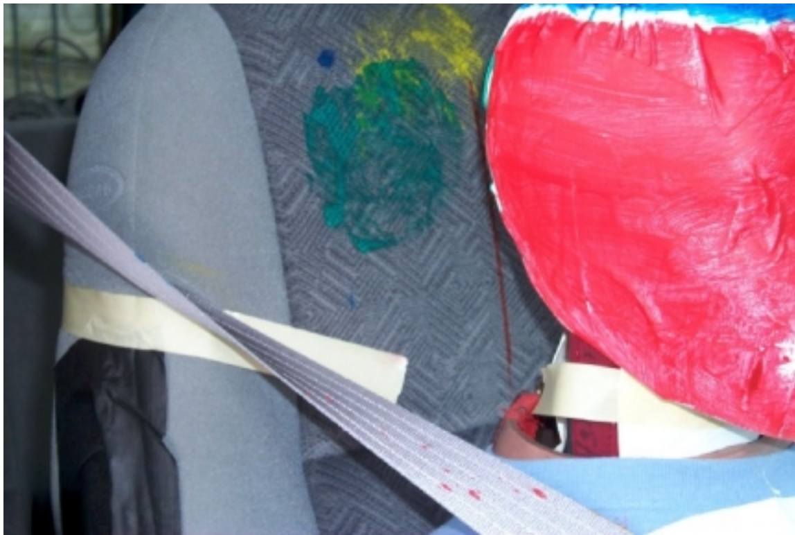
63. Point de contact de tête du passager, véhicule bélière, après essai. Passenger's head contact point, bullet vehicle, post-test.
