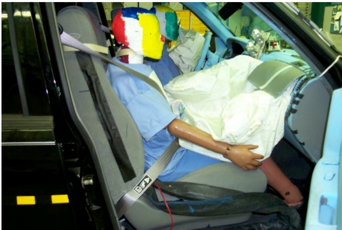
61. Position du passager, véhicule bélière, après essai. Passenger's position, bullet vehicle, post-test.
