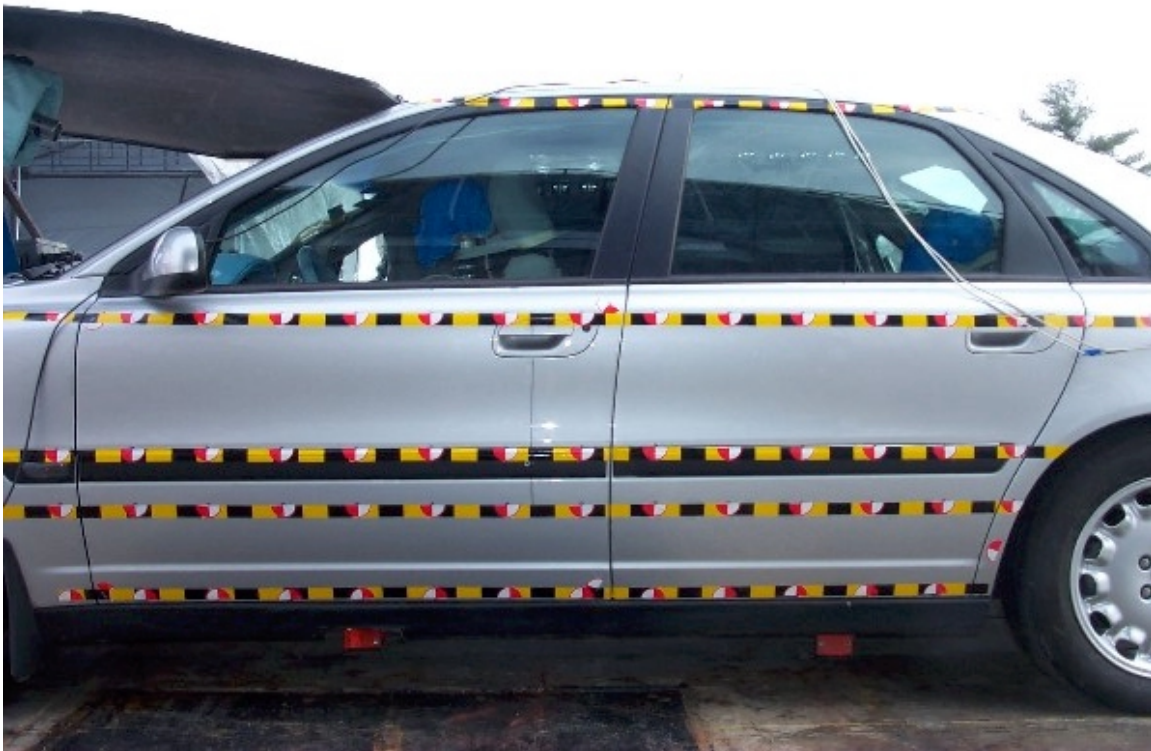
23. Surface ciblée côté gauche du véhicule cible, avant essai. Targets on left side of target vehicle, pre-test.
