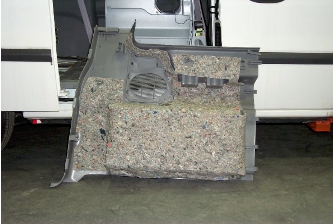
35. Mousse de protection située dans la garniture de la porte arrière gauche. Protective foam located in left rear door trim.
