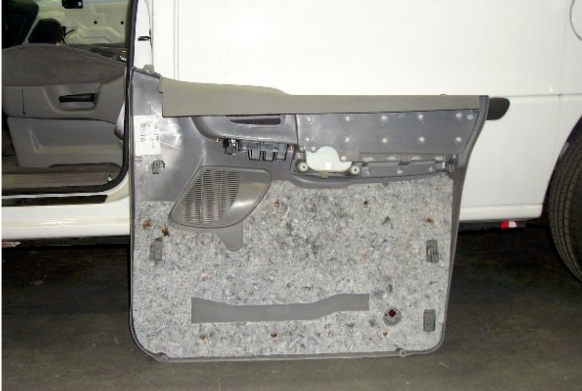
33. Mousse de protection située dans la garniture de la porte avant gauche. Protective foam located in left front door trim.
