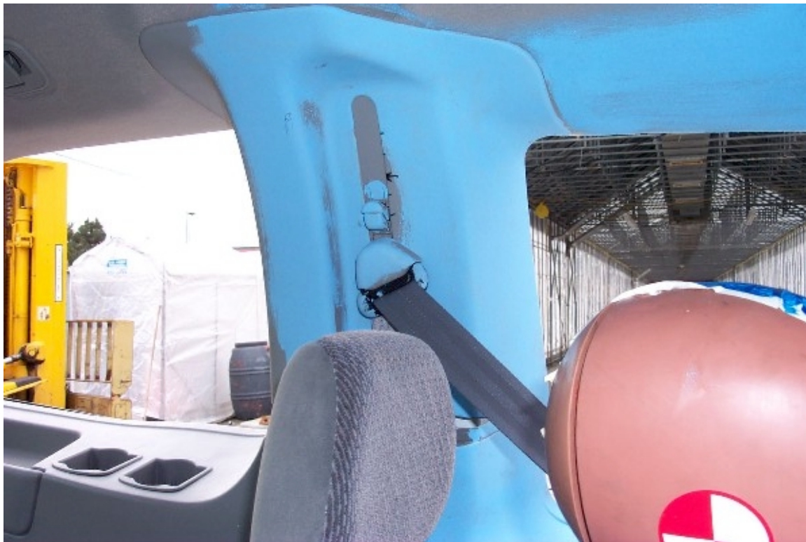
52. Cadre de fenêtre et pilier "C" du côté gauche, véhicule cible, après essai. Window edge and left side "C" pillar, target vehicle, post-test.
