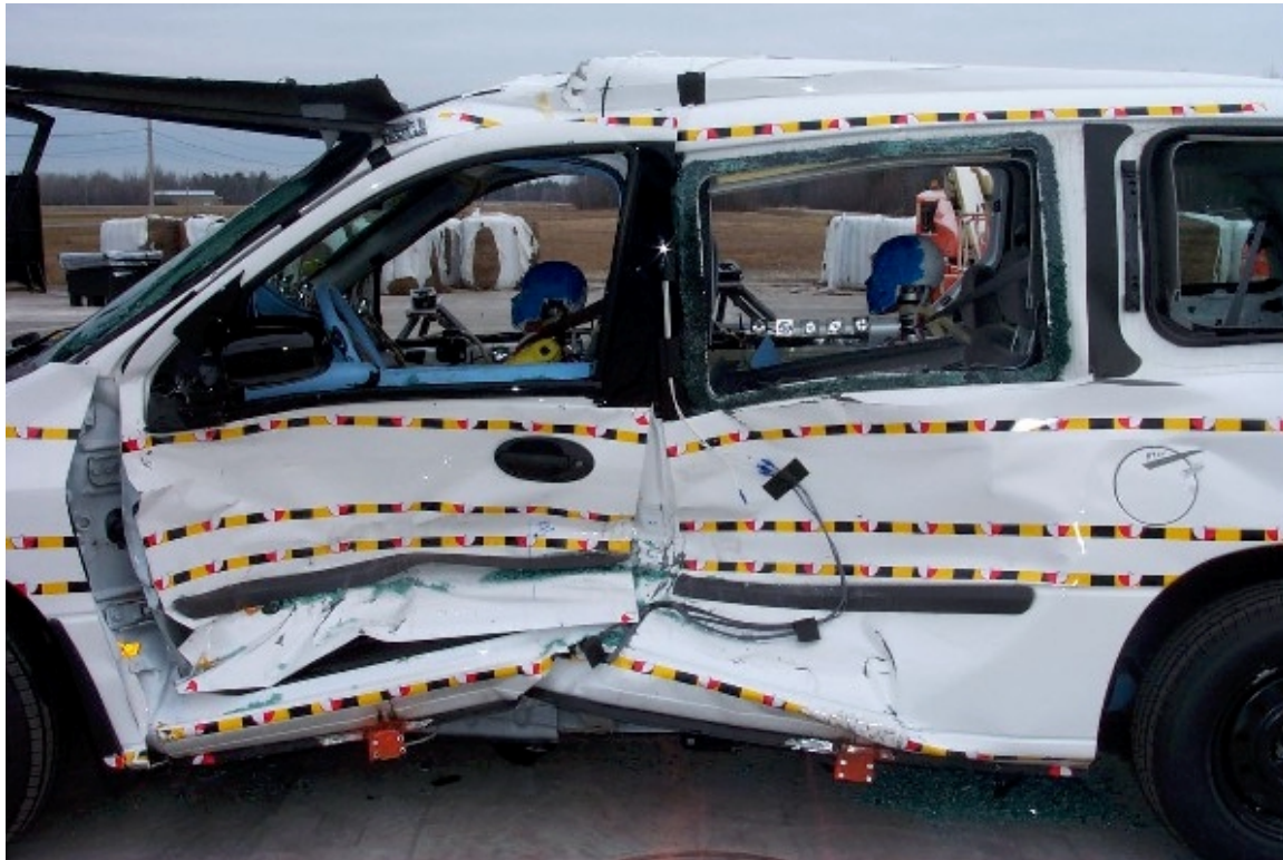
24. Surface ciblée côté gauche du véhicule cible, après essai. Targets on left side of target vehicle, post-test.
