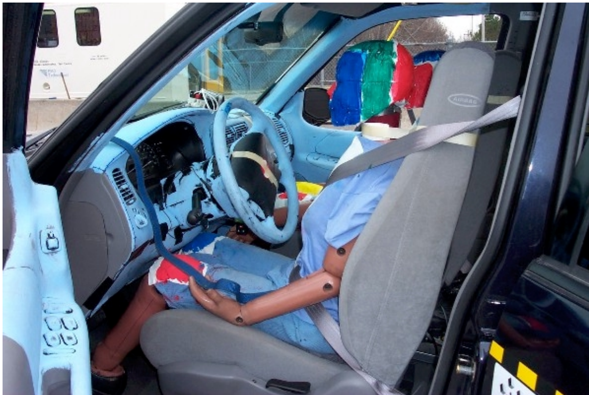
56. Position du conducteur, véhicule bélier, après essai. Driver's position, bullet vehicle, post-test.
