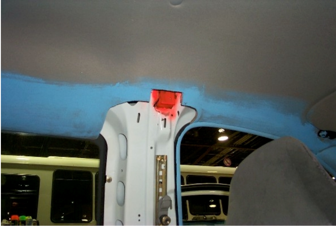
39. Position des accéléromètres sur le pilier "B". Position of accelerometers on "B"pillar.
