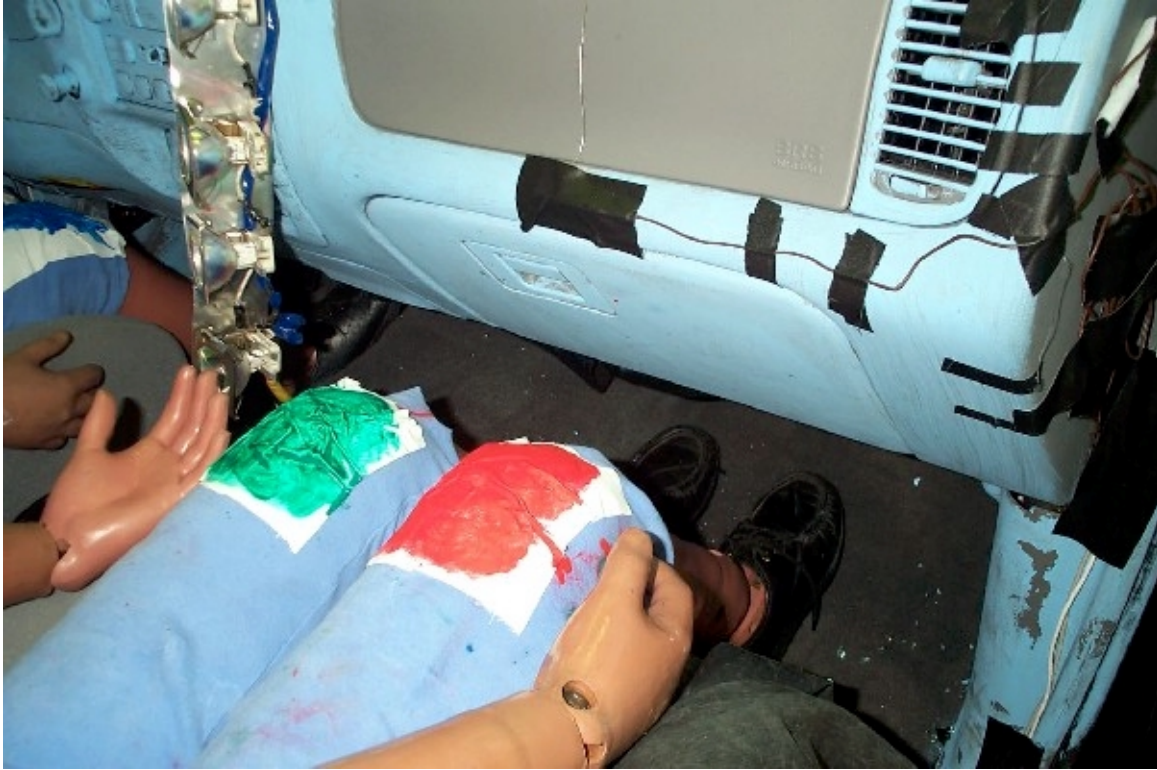
60. Point de contact des genoux du passager, véhicule bélière, après essai. Passenger's knees contact points, bullet vehicle, post-test.
