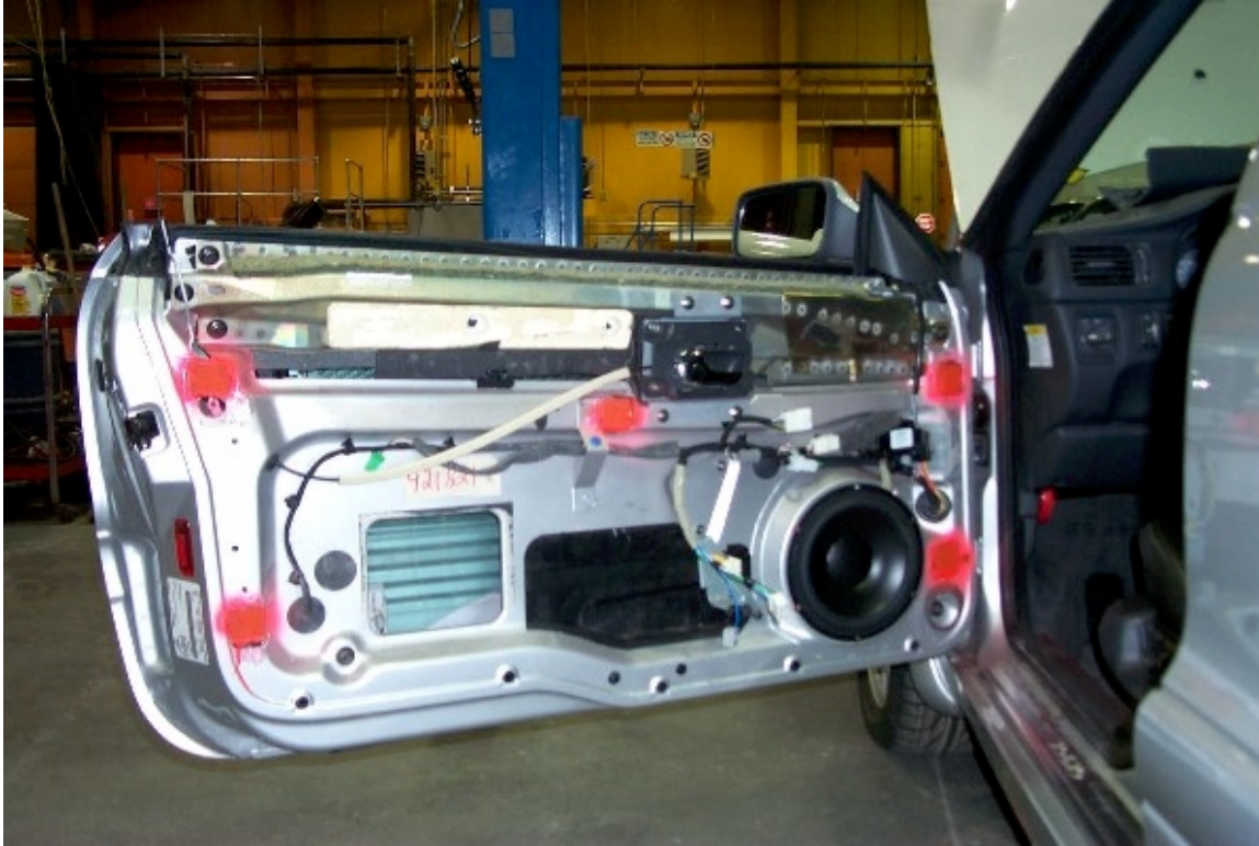
36. Position des accéléromètres dans la porte avant gauche. Position of accelerometers in front left door.
