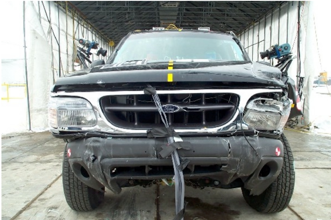
10. Vue générale avant du véhicule bélier, après essai. General front view of bullet vehicle, post-test.
