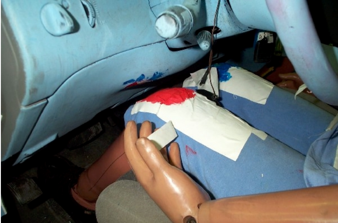
55. Point de contact des genoux du conducteur, véhicule bélier, après essai. Driver's knees contact points, bullet vehicle, post-test.
