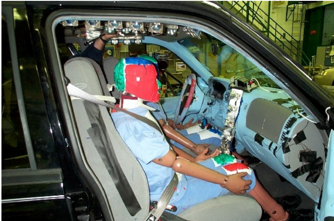
57. Position du passager, véhicule bélier, après essai. Passenger's position, bullet vehicle, post-test.
