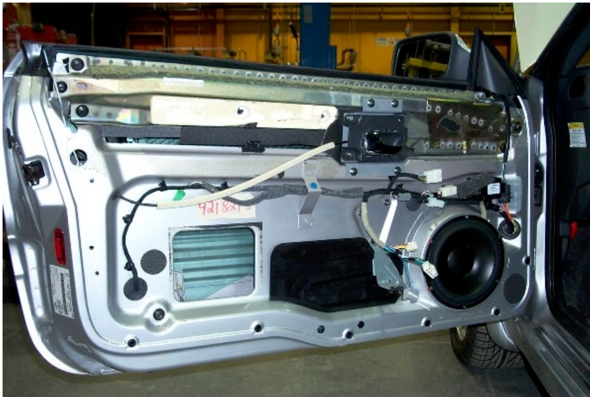
34. Mousse de protection à l'intérieur de la porte avant gauche. Protective foam inside left front door.
