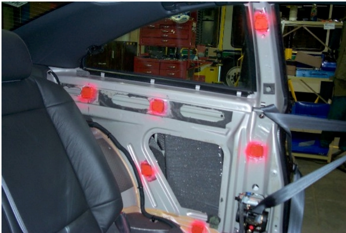
37. Position des accéléromètres du côté arrière gauche et pilier "B". Position of accelerometers in rear left and "B" pillar.
