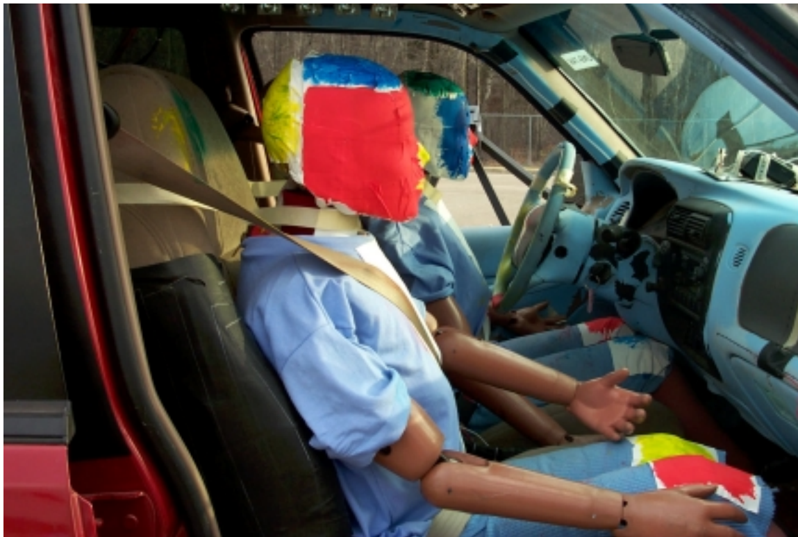
61. Position du passager, véhicule béliier, après essai. Passenger's position, bullet vehicle, post-test.
