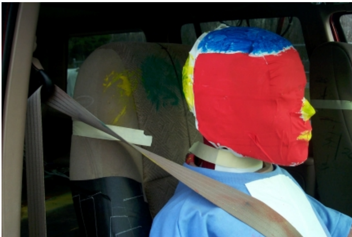
63. Point de contact de tête du passager, véhicule béliier, après essai. Passenger's head contact point, bullet vehicle, post-test.
