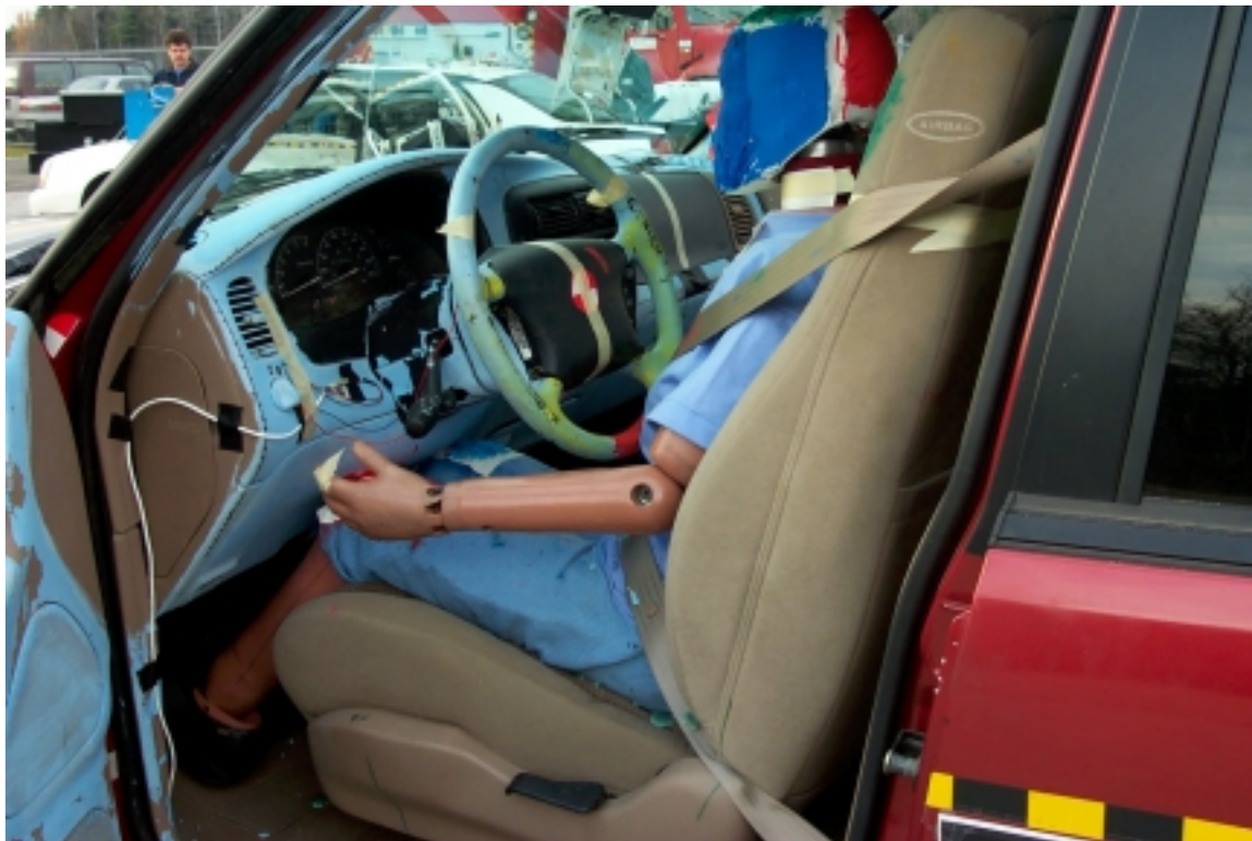
56. Position du conducteur, véhicule bête, après essai. Driver's position, bullet vehicle, post-test.
