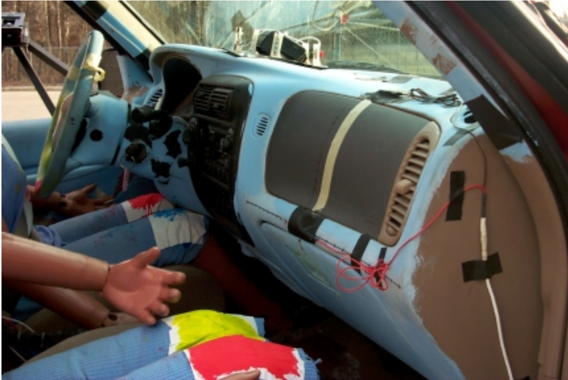
62. Point de contact de tête du passager, véhicule béliier, après essai. Passenger's head contact point, bullet vehicle, post-test.
